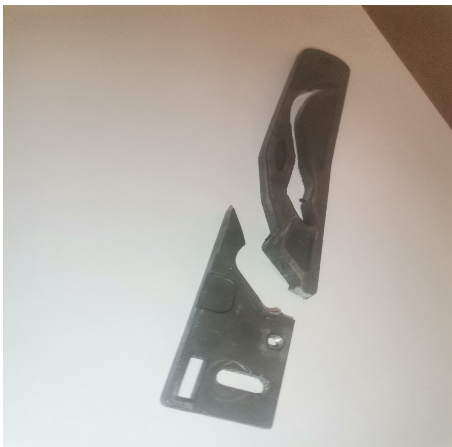
Slika 24. Slika vodilice s puknućem na kritičnom mjestu
