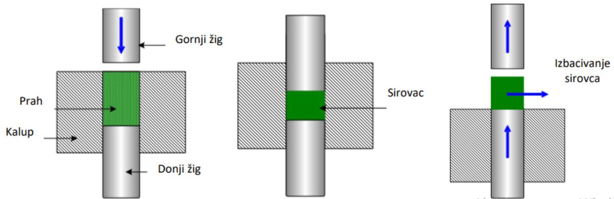
Slika 6. Shematski prikaz jednoosnog kompaktiranja u kalupu [6]
