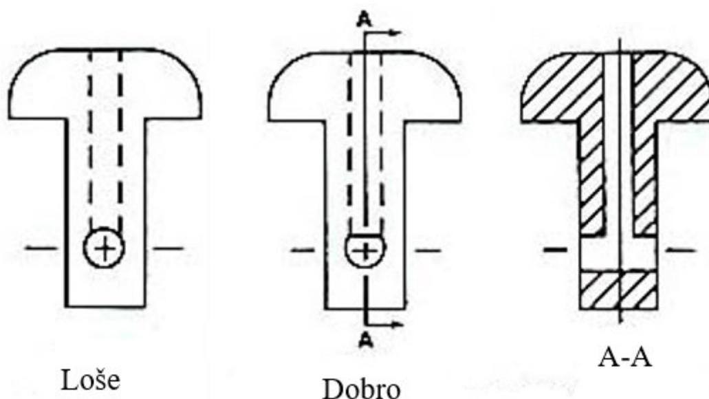
Slika 14. Primjer korištenja umetaka za ostvarivanje uvrta i provrta[11]
