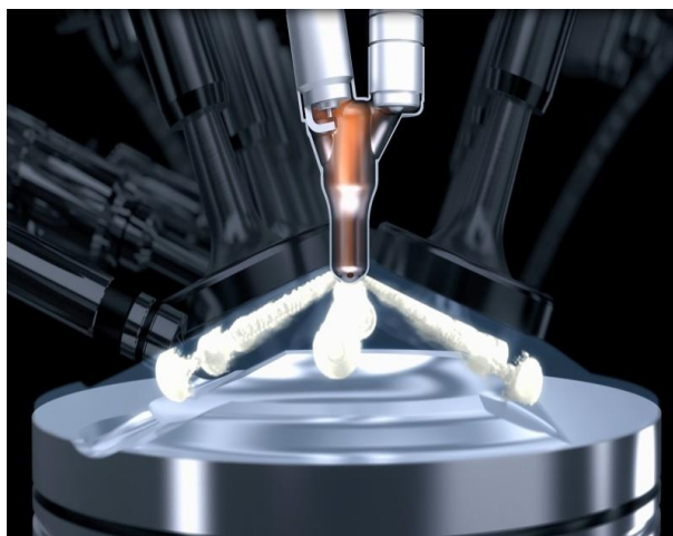
Slika 7. Aktivna pretkomora tvrtke MAHLE Powertrain [10]
