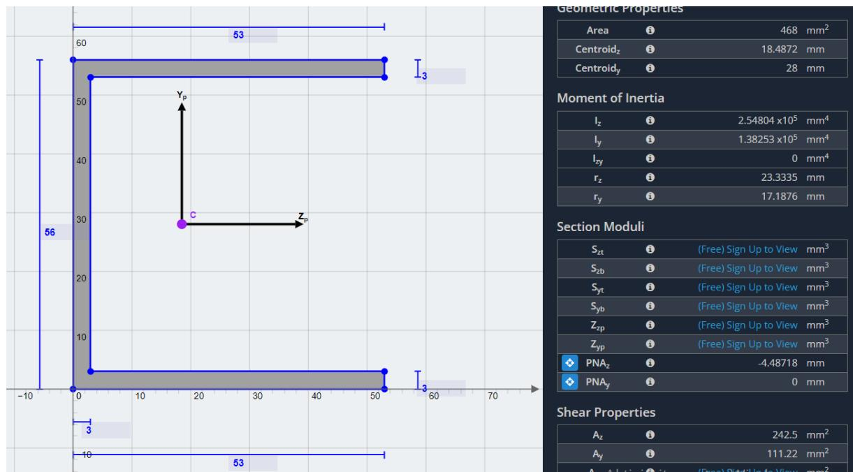
Slika 62. Moment tromosti i težište zavara [27]
