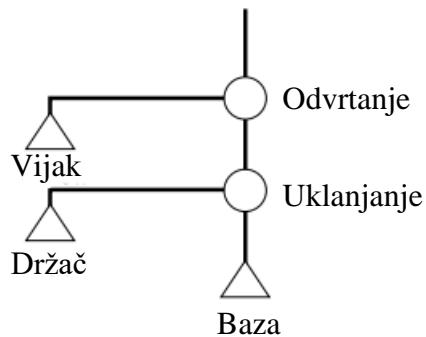
Slika 3. Dijagram toka odvajanja držača pričvršćenog vijkom
