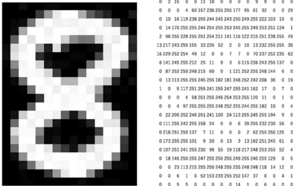
Slika 2. Slika i način na koji računalo pohranjuje sliku [2]
