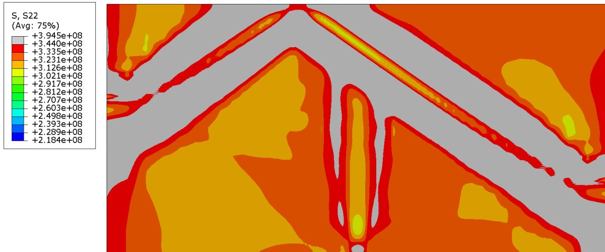
Slika 43. Normalna komponenta naprezanja \sigma_y za mrežu sa 122980 C3D8I elemenata
