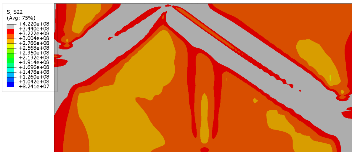
Slika 60. Normalna komponenta napreznaja \sigma_y - 83448 C3D8I elemenata
