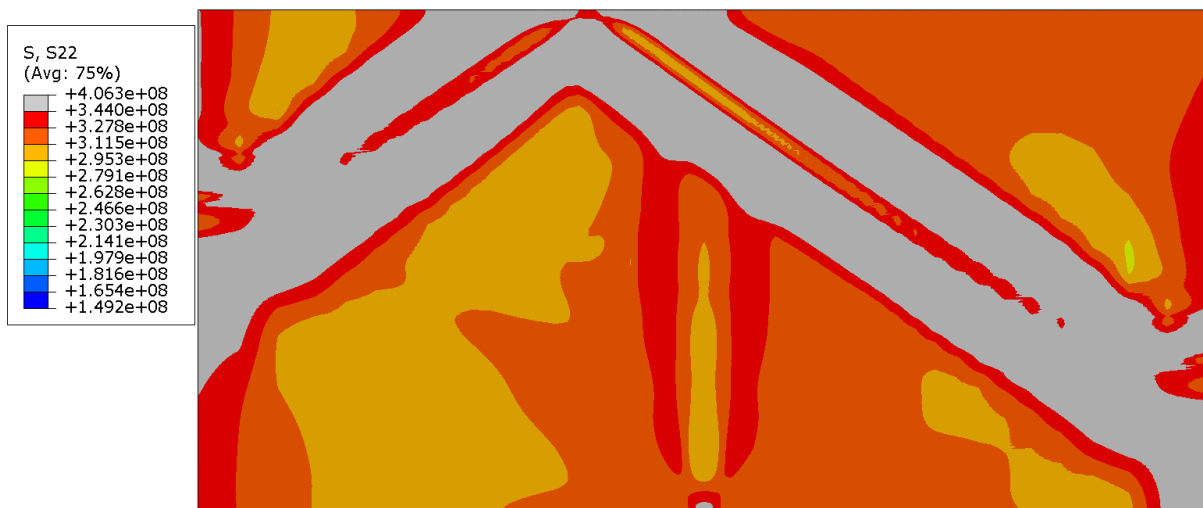
Slika 52. Normalna komponenta napreznja \sigma_y - 122980 C3D8I elemenata
