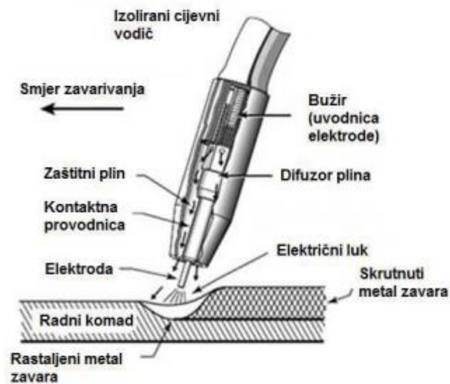
Slika 4. MAG zavarivanje [8]
