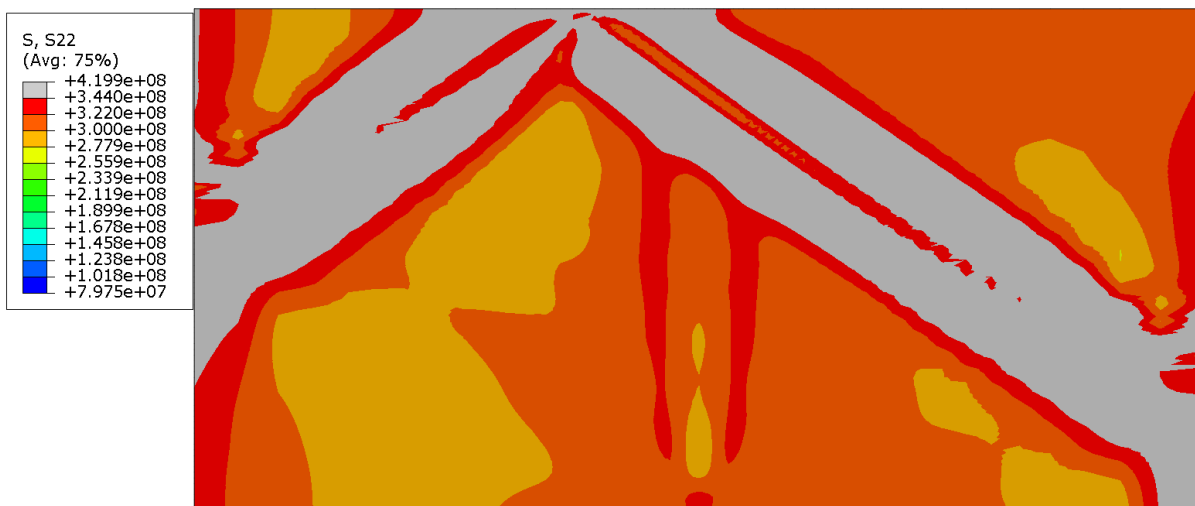
Slika 59. Normalna komponenta napreznaja \sigma_y - 48960 C3D8I elemenata
