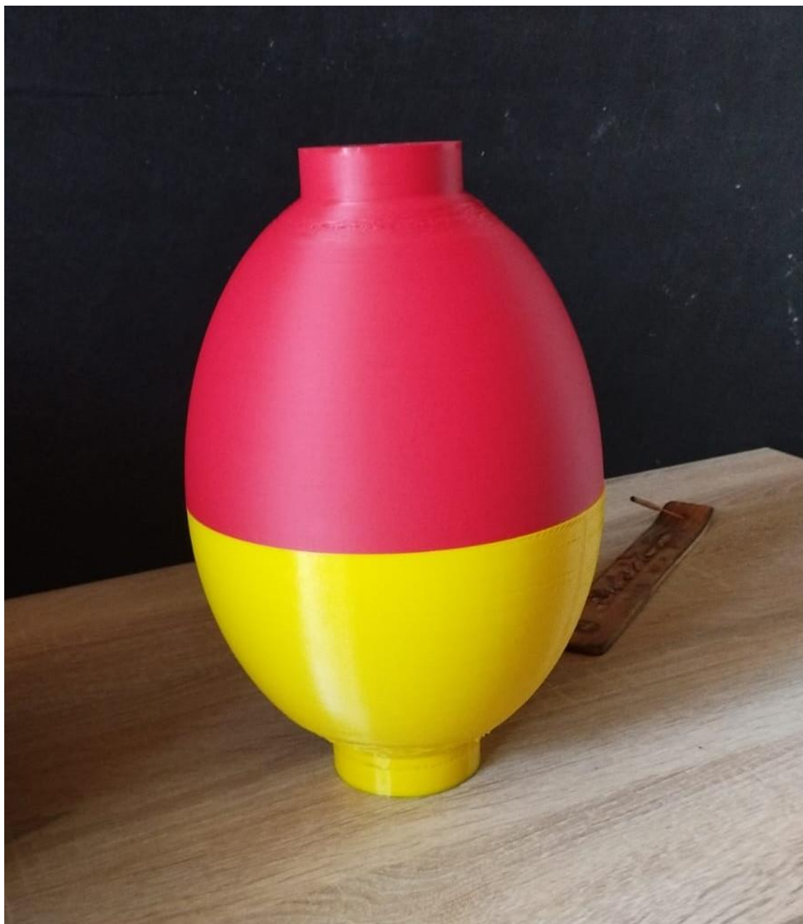
Slika 24. Kalup izveden u četiri dijela
