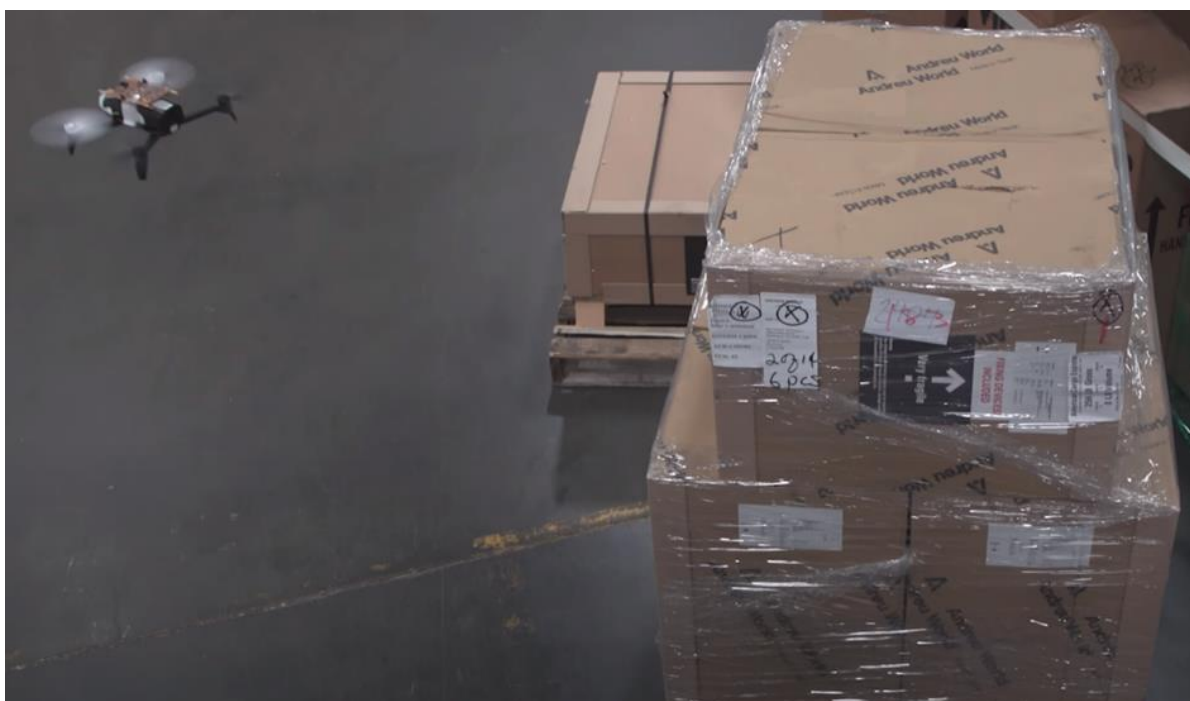
Slika 27. Prikaz veličine drona i očitavanje RFID tagova [47]
