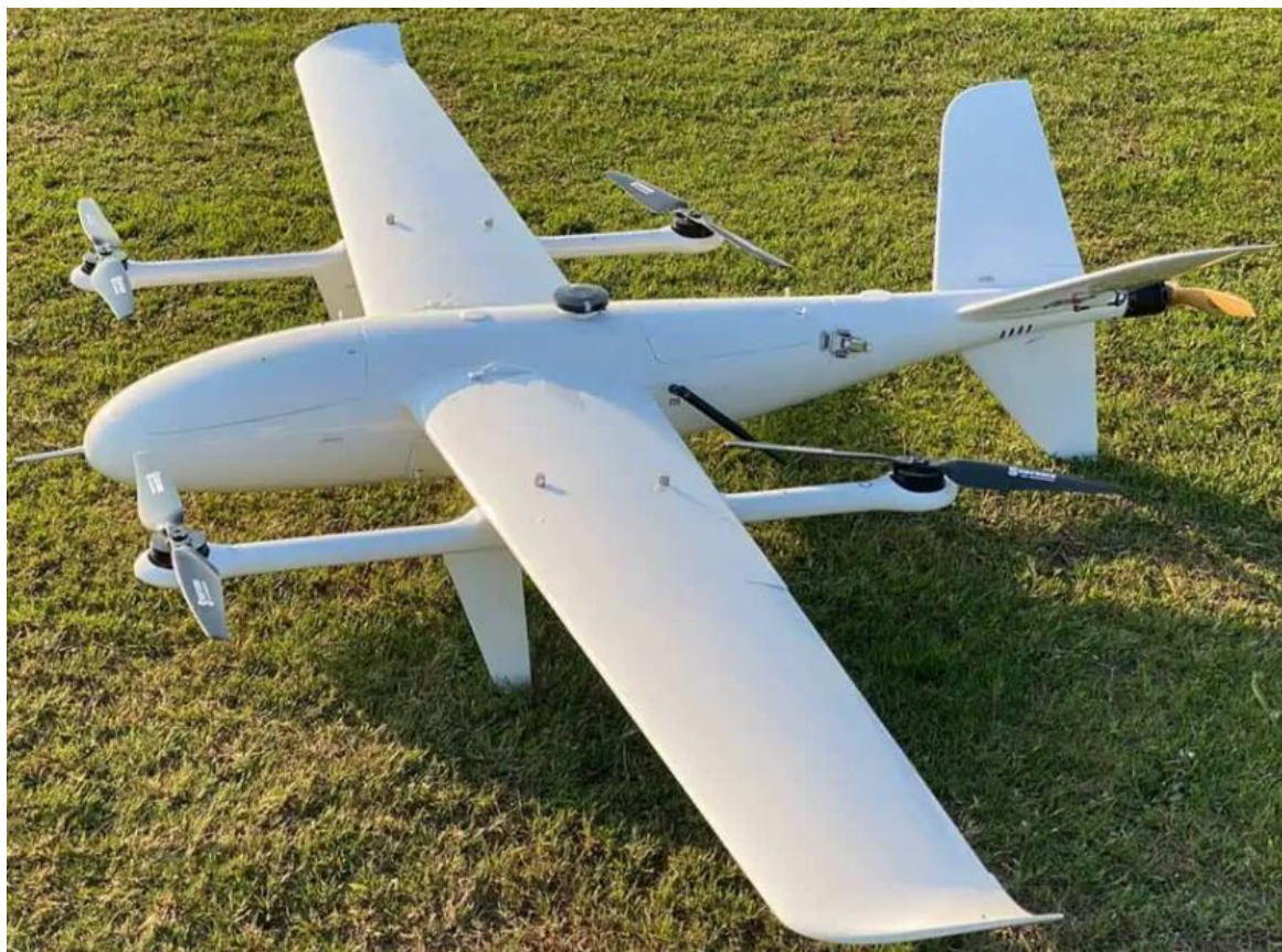
Slika 13. Dron s fiksnim krilima i vertikalnim uzlijetanjem [22]
