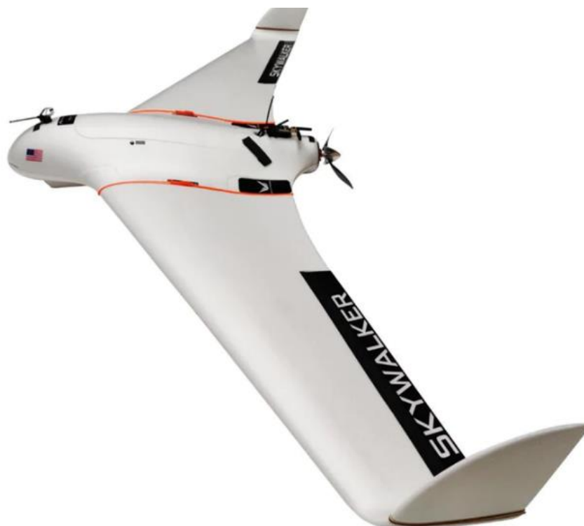
Slika 11. Dron s fiksnim krilima [20]
