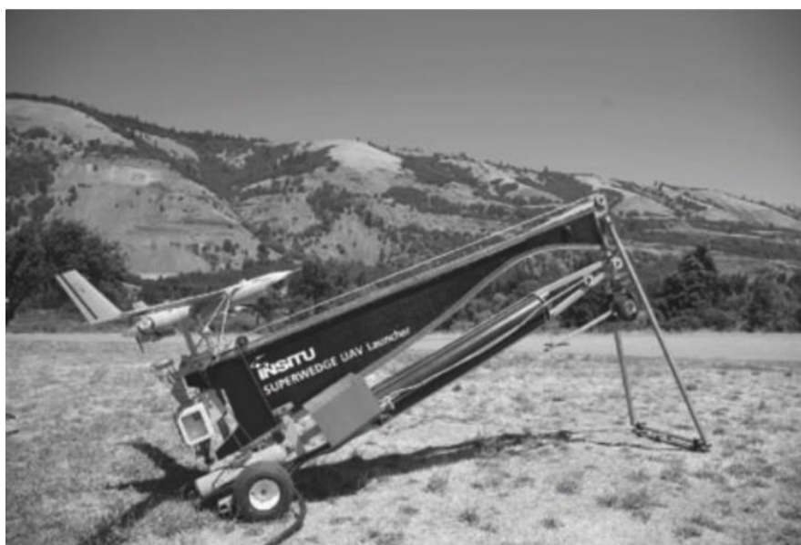
Slika 20. Lansiranje drona pomoću katapulta [28]
