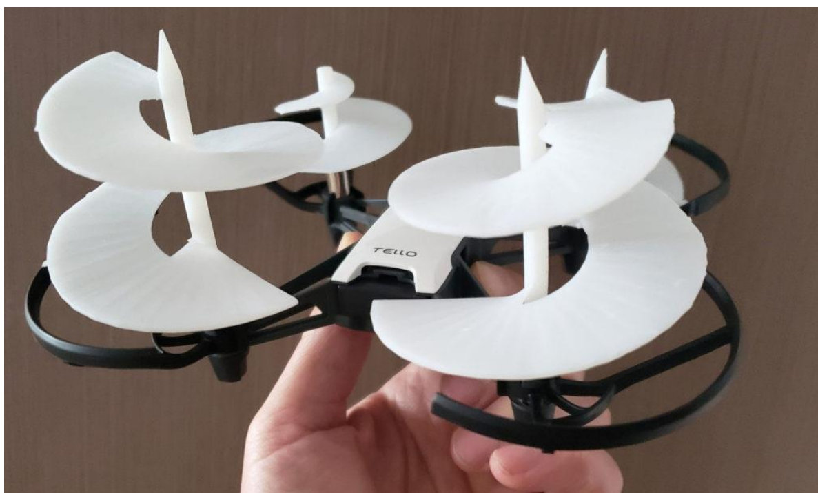
Slika 4. Moderna rekonstrukcija Zračnog vijka [4]
