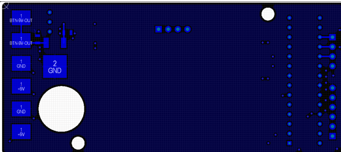
Slika 38. Četvrti (BOTTOM) sloj tiskane pločice
