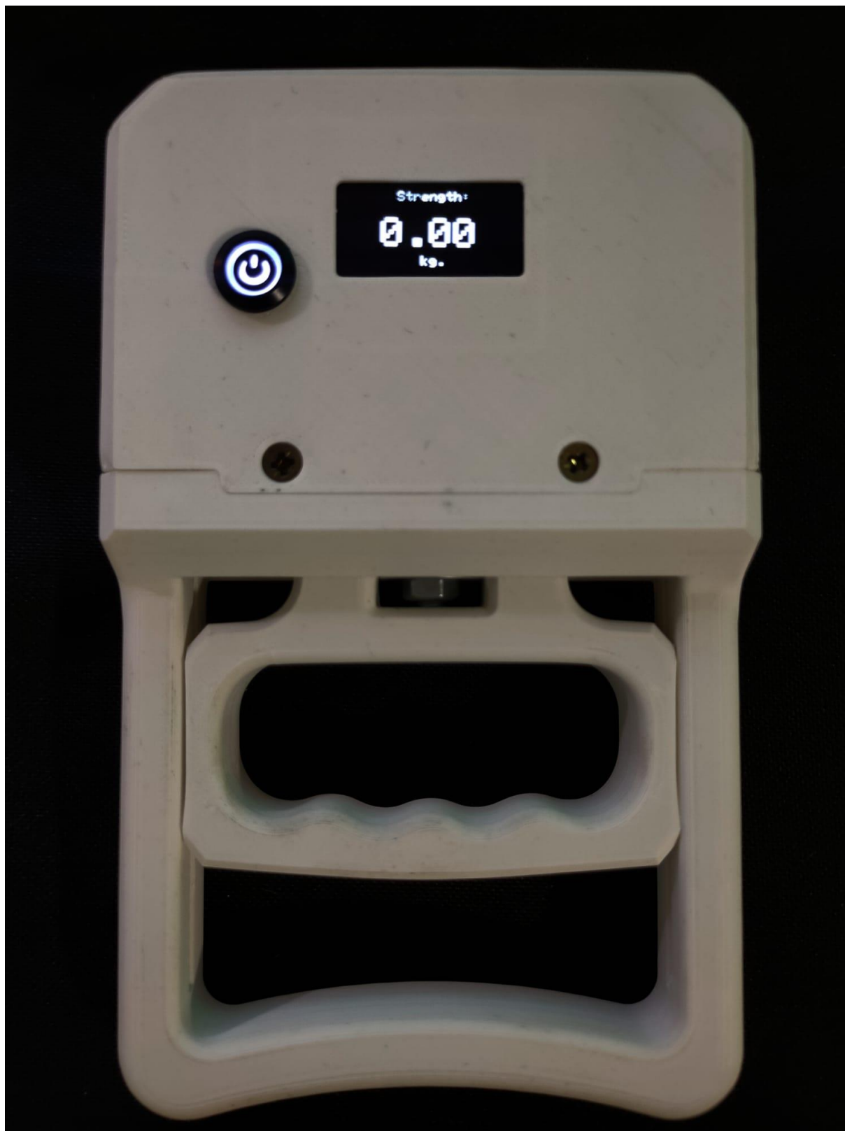
Slika 43. Uključen i neopterećen dinamometar
