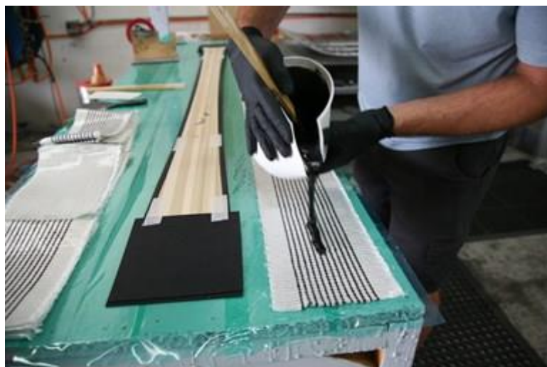
Slika 10. Dodavanje grafena pri izradi kompozita [14]
