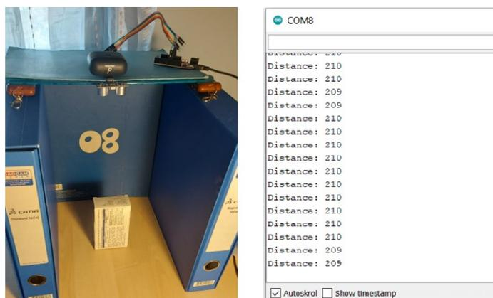
Slika 34. Mjerenje udaljenosti jednog predmeta
