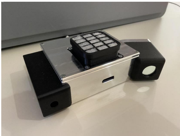
Slika 1. Sklop lasera i kamere
