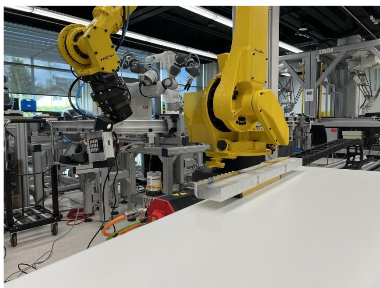
Slika 2. Sustav laser-kamera montirani na robotu Fanuc M710
