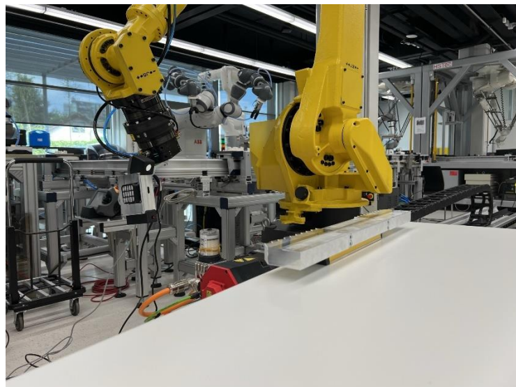
Slika 2. Sustav laser-kamera montirani na robotu Fanuc M710
