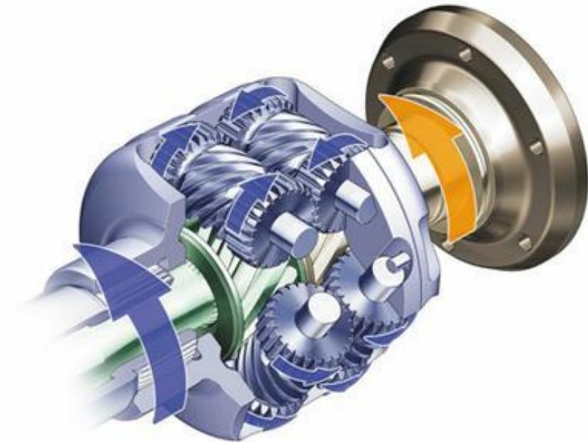
Slika 4. Torsen diferencijal[3]
