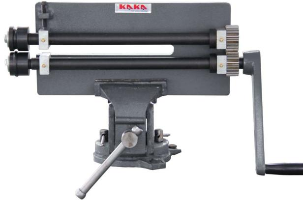
Slika 10. Uređaj za užljebljenje lima [8]
