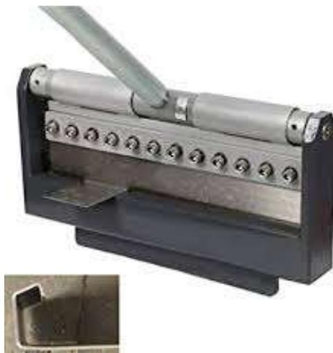
Slika 3. Uređaj za savijanje V-profila [3]
