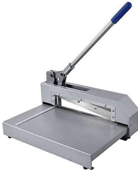
Slika 7. Uređaj za odsijecanje lima [5]
