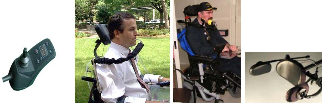
Slika 4 Razni sustavi upravljanja motoriziranih kolica (s lijeva na desno): upravljanje palicom, upravljanje dahom, upravljanje bradom, upravljanje glavom
