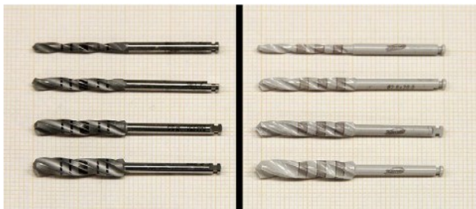
Slika 33. Svrdla: čelična (lijevo) i keramička (desno) [52]
