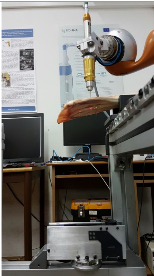
Slika 72. Robotsko bušenje teleće lopatične kosti [74]
