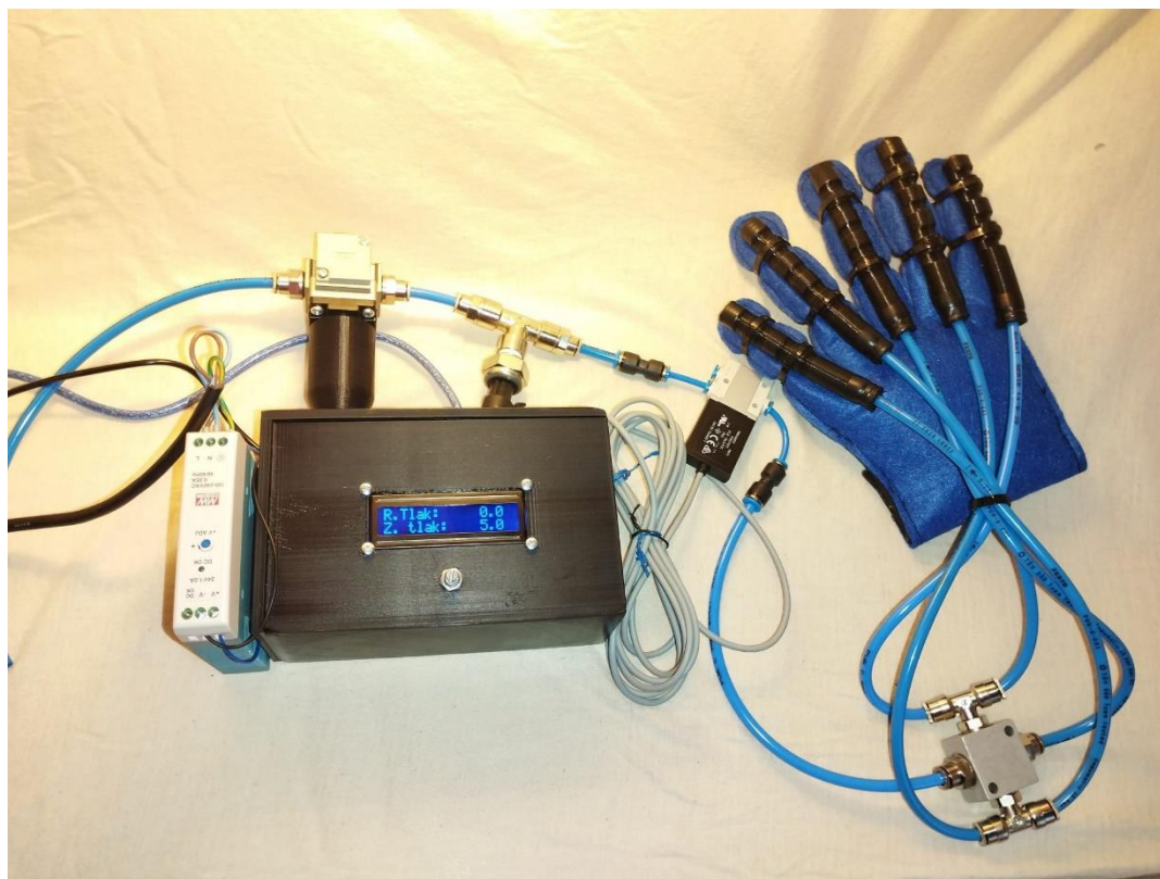
Slika 3 Konstruktivna izvedba pneumatske rukavice
