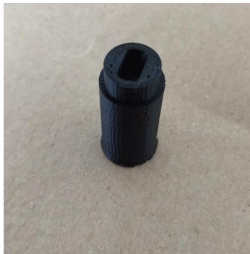
**Slika 19 Spojka između motora i regulatora tlaka**
