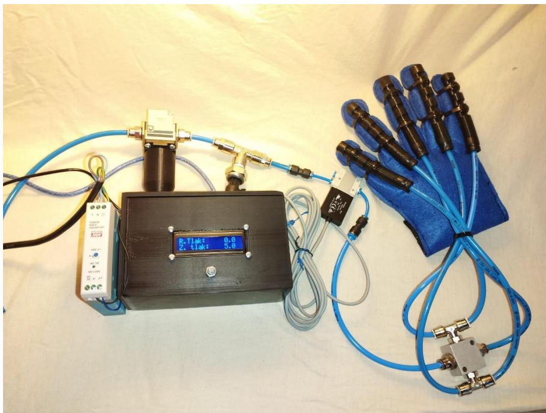
**Slika 3 Konstrukcijska izvedba pneumatske rukavice**
