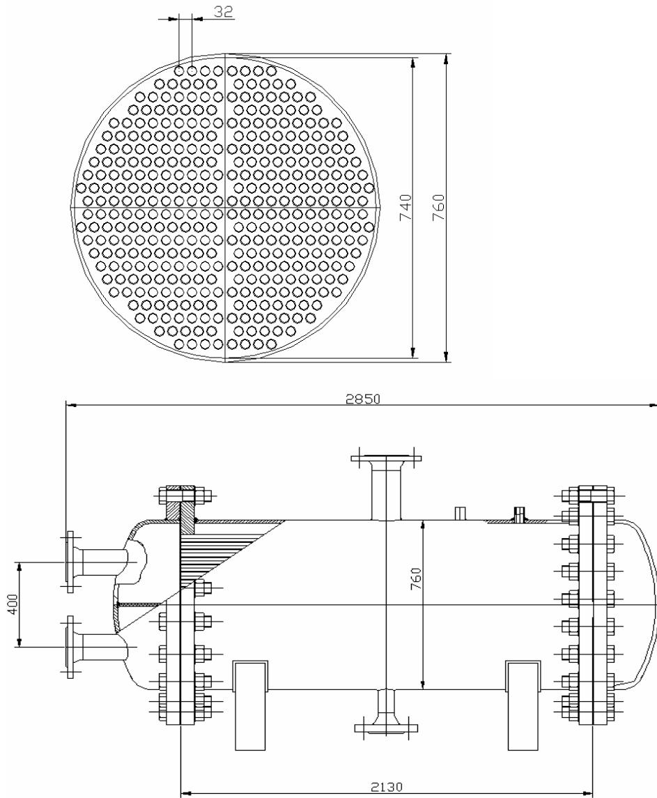
Slika 49: Prikaz dimenzija kondenzatora s cijevima u plaštu
