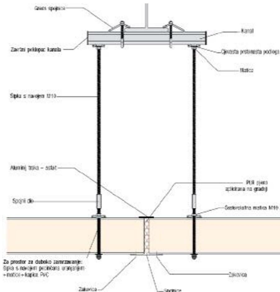
Slika 13: Spajanje panela kao spušteni strop, način 1
