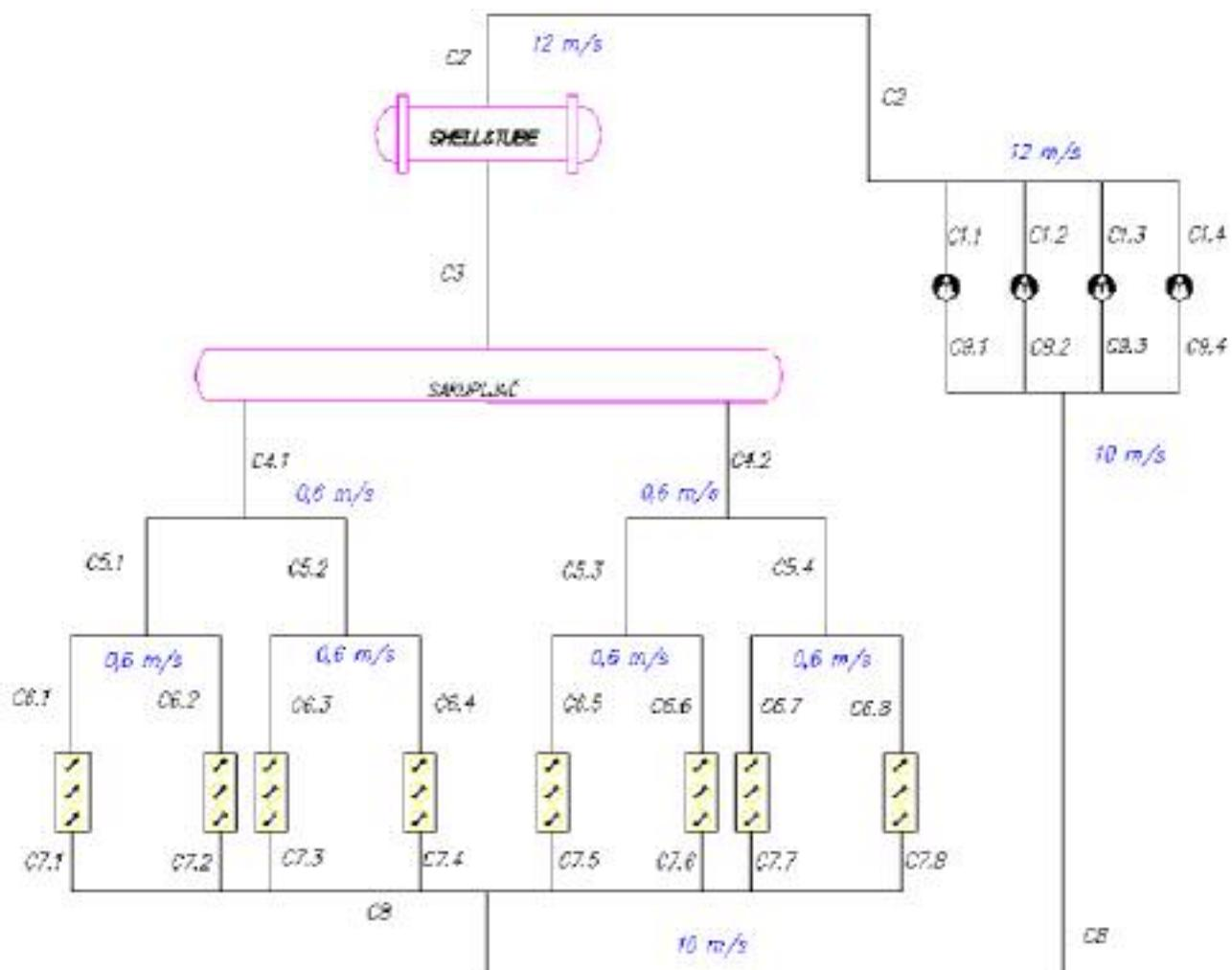
Slika 50: Shema spajanja s oznakom broja cjevovoda
