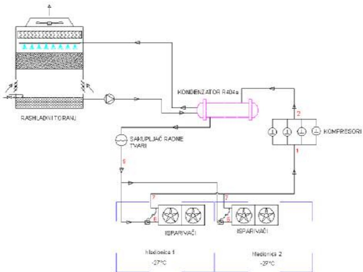
Slika 40: Shematski prikaz rashladnog sustava
