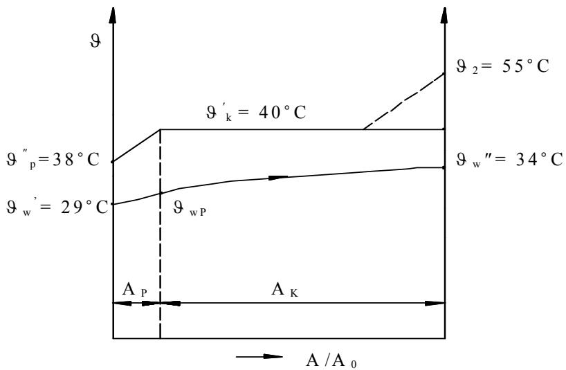
Slika 48:  $\vartheta$ -A dijagram za kondenzator
