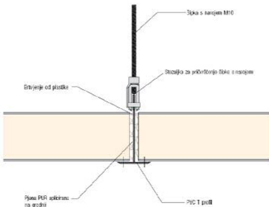
Slika 14: Spajanje panela kao spušteni strop, način 2
