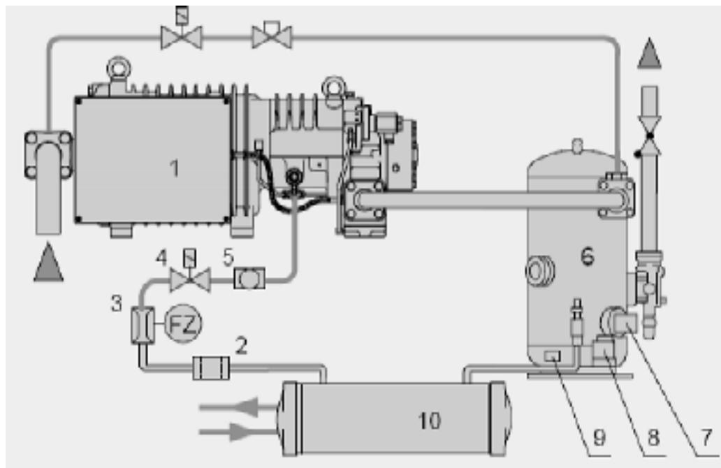
Slika 38: Prikaz spajanja poluhermetičkog vijčanog kompresora na sustav
