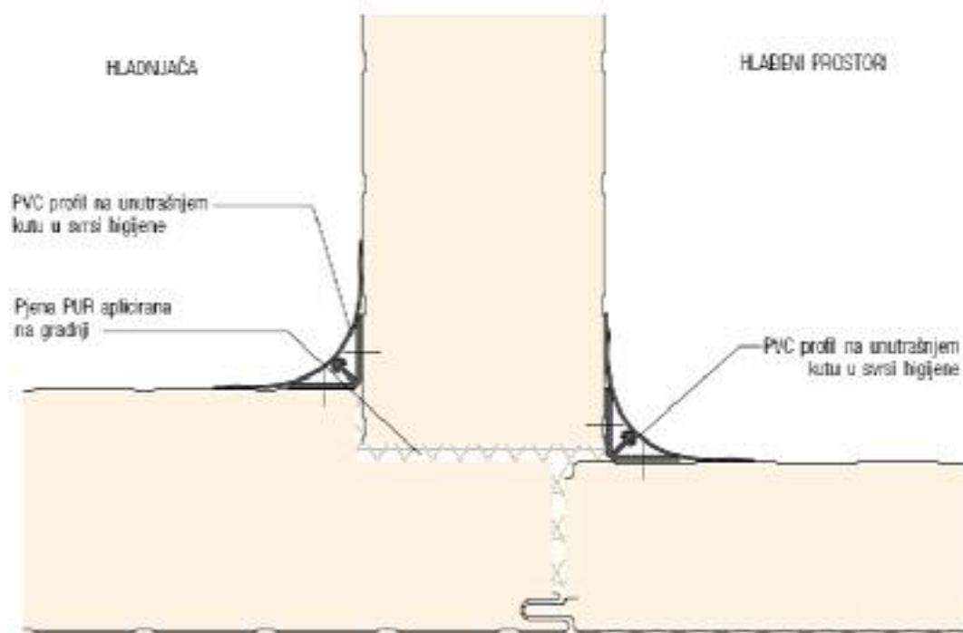
Slika 11: Prikaz ugradnje panela između dvije hladnjače
