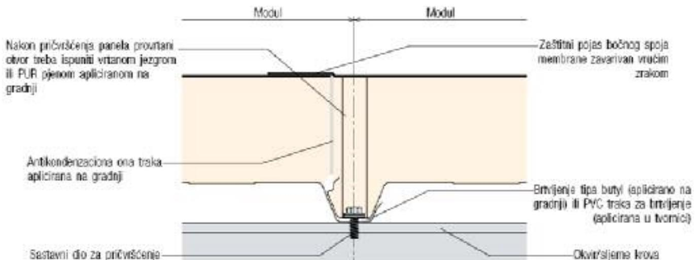
Slika 09: Prikaz spajanja dva zidna panela, način 2
