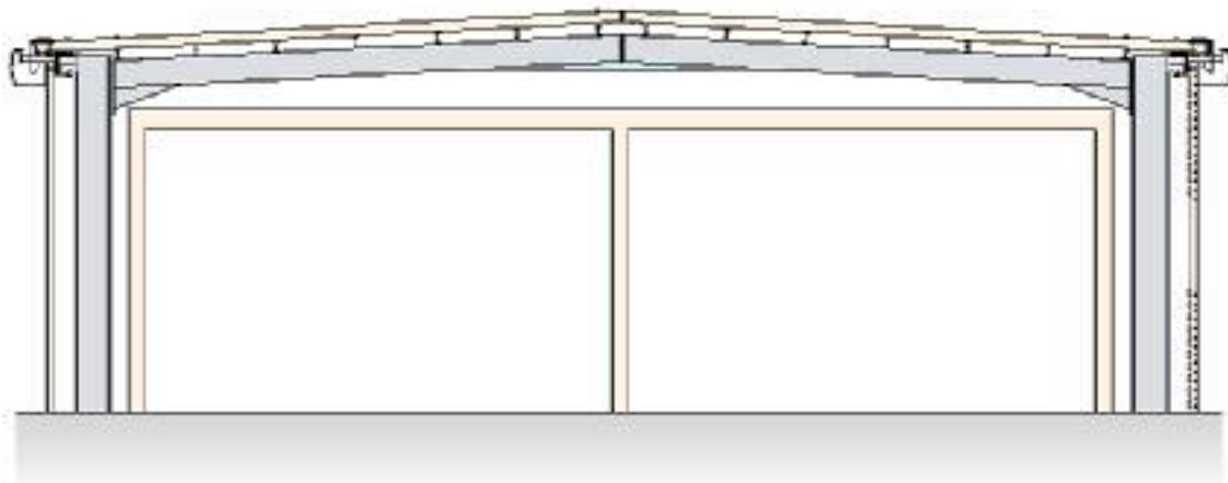
Slika 03: Prikaz položaja panela i konstrukcije hladnjače
