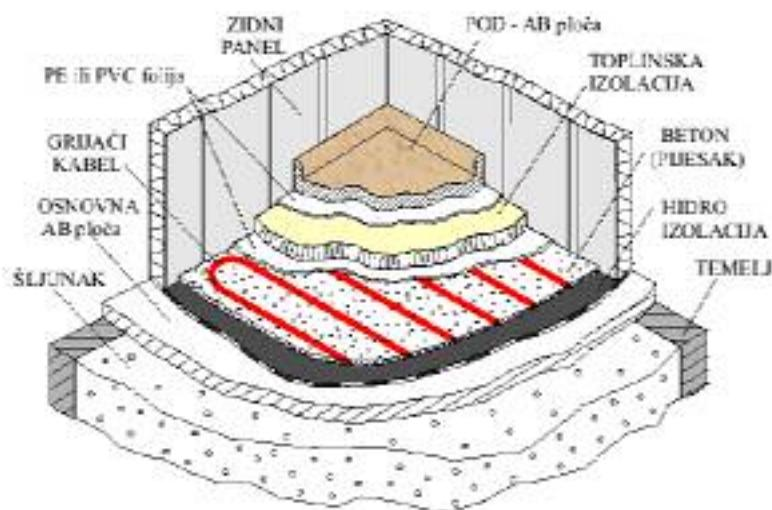
Slika 17: Prikaz postavljanja grijajućih električnih kabela u pod
