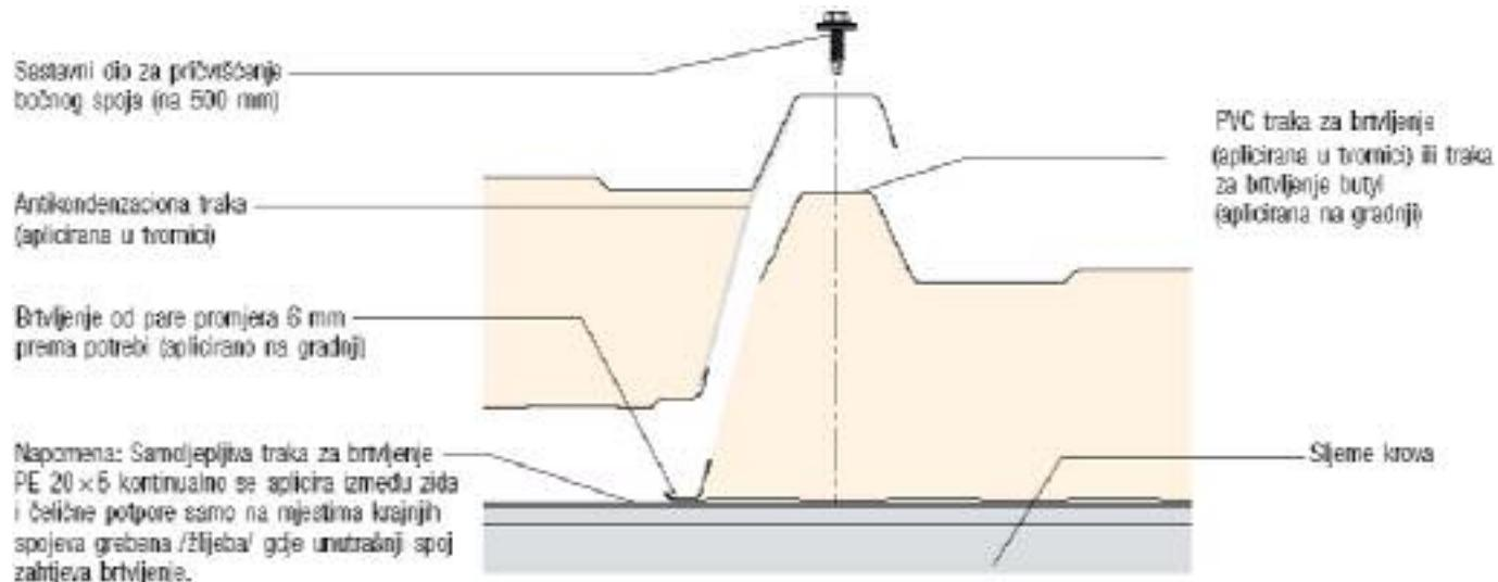
slika 08: Prikaz spajanja dva zidna panela, način 1
