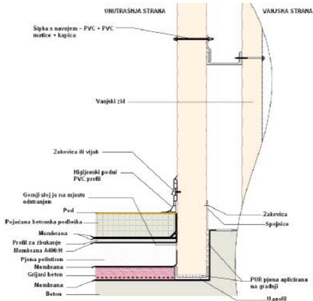
Slika 12: Prikaz spajanja zidnih panela i ugradnja u pod hladnjače
