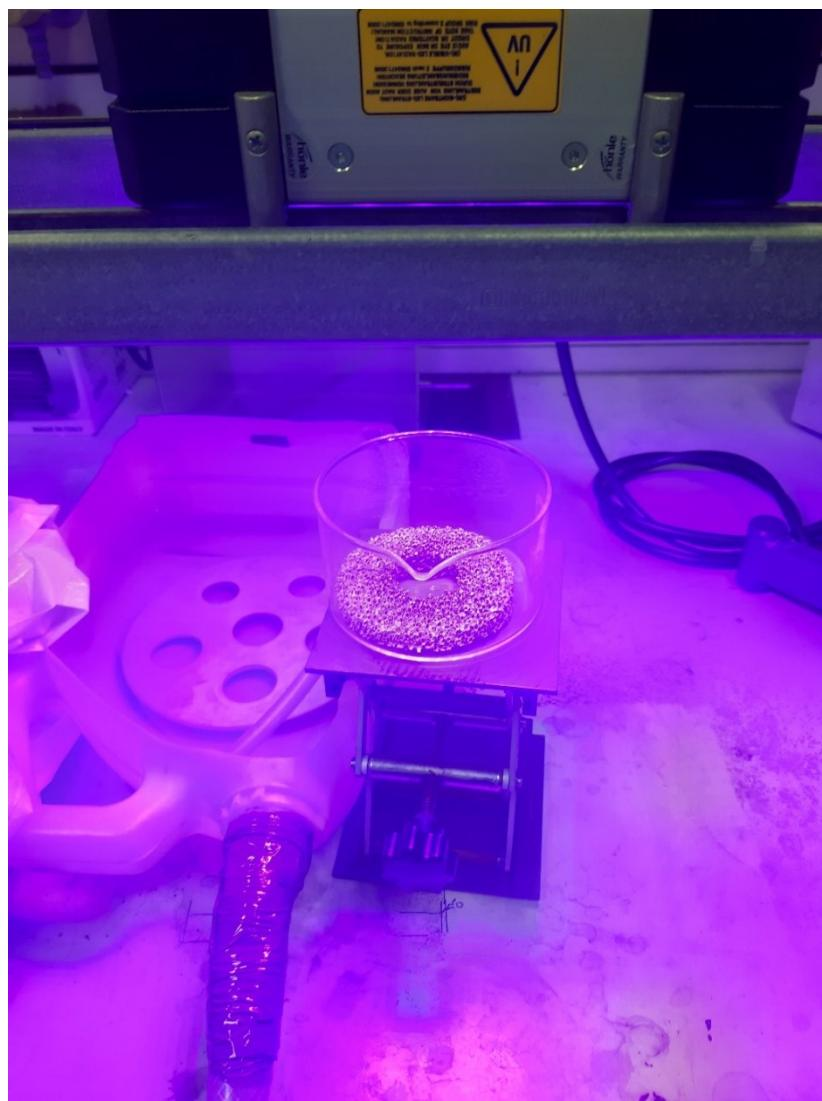
Slika 29. Sterilizacija keramičkog vijenca pod UV lampom
