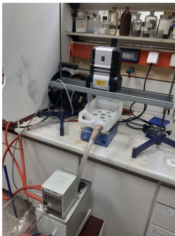
Slika 22. Eksperimentalni postav za UV lampu sa cirkulacijskim sustavom i magnetskom miješalicom
