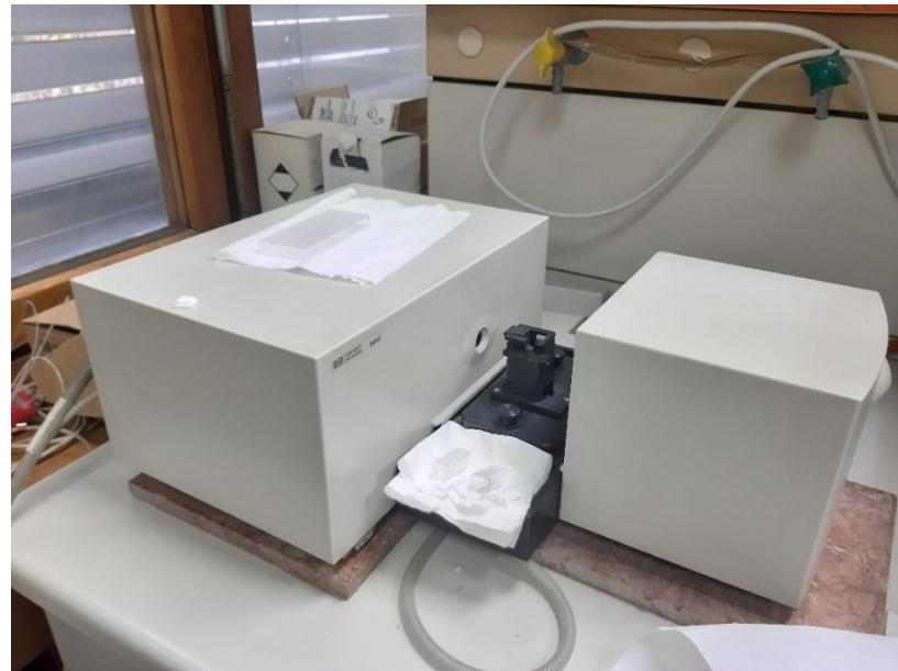
**Slika 26. Spektrofotometar**
