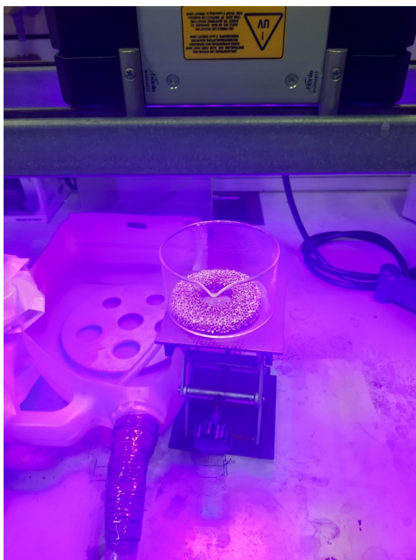
Slika 29. Sterilizacija keramičkog vijenca pod UV lampom
