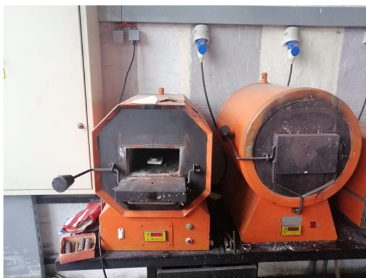
Slika 20. Homogenizacijsko žarenje uzoraka
