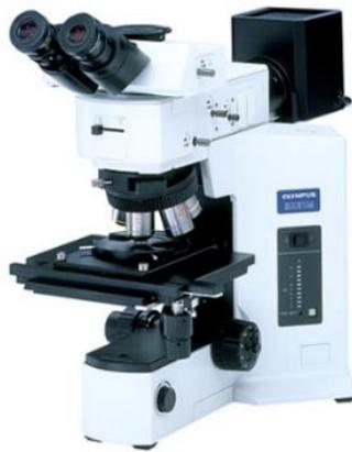
**Slika 17. Sastavni dijelovi svjetlosnog miroskopa: 1 Tijelo mikroskopa, 2 Stolić, 3 Dijelovi za fokusiranje slike, 4 Sustava za iluminaciju, 5 Optičke komponente [24]**
