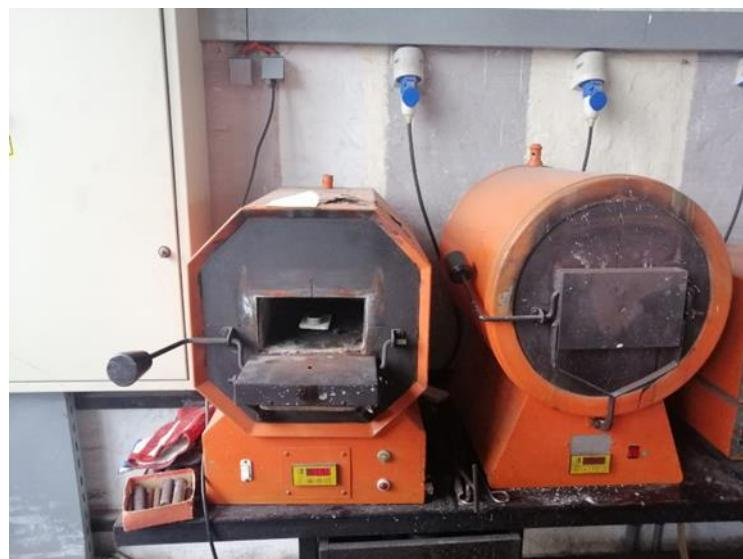
Slika 20. Homogenizacijsko žarenje uzorka
