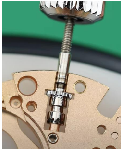
Slika 38. Spoj krune, drška krune, kliznog i zavojnog zupčanika [20]
