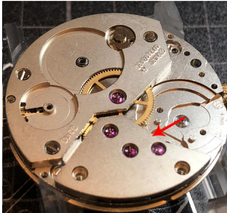
Slika 22. Most za lanac zupčanika [8]
