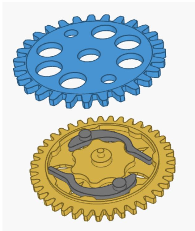
Slika 44. Dijelovi prekrenog zupčanika [5]
