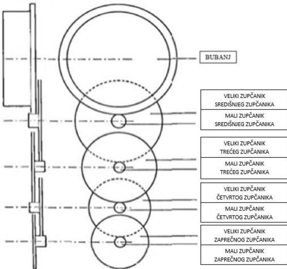
Slika 52. Raspored zupčanika u lancu kotača [24]
