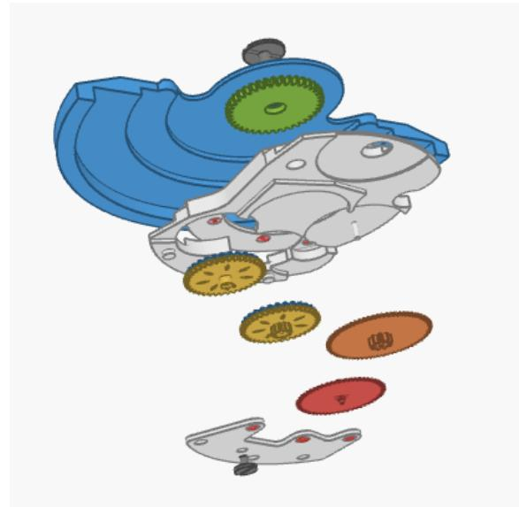
Slika 42. Dijelovi mehanizma automatskog navijanja sata [5]
