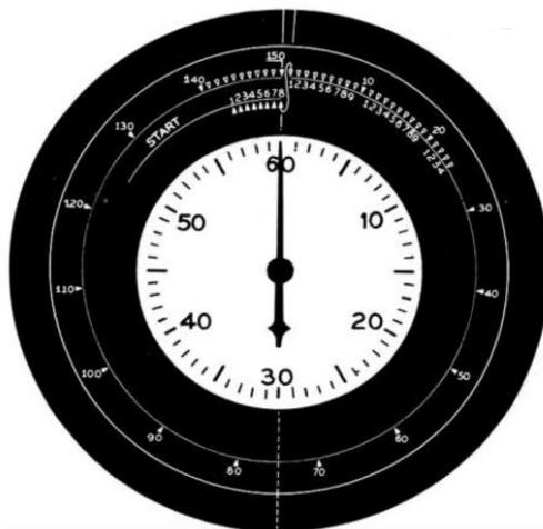
Slika 65. Praćenje sekundi i broj vibracija [27]
