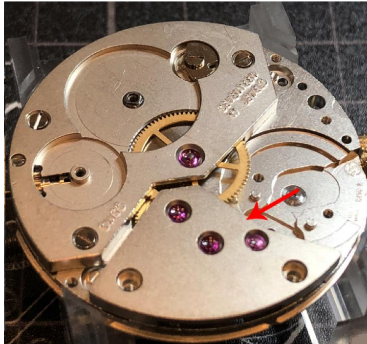
Slika 22. Most za lanac zupčanika [8]
