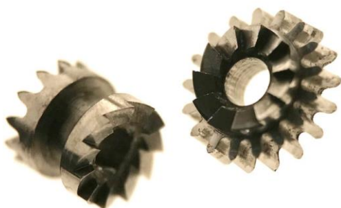
Slika 37. Klizni i zavojni zupčanik [19]
