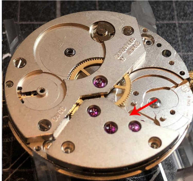
Slika 22. Most za lanac zupčanika [8]
