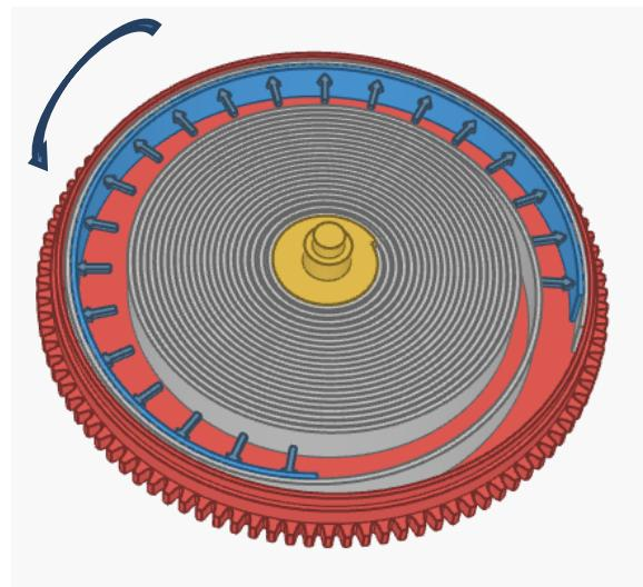
Slika 11. Namotana opruga u kućištu i pokretanje kućišta [5]
