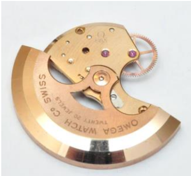
Slika 41. Mehanizam automatskog navijanja sata [21]
