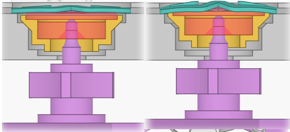
Slika 31. Princip rada zaštite nemirnice [5]
