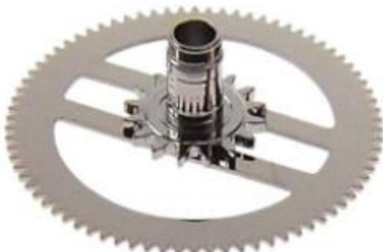
Montiraju se skupa u središte sata. Pogonski zupčanik je u zahvatu s trećim zupčanikom, točnije s njegovim manjim zupčanikom, koji ga pokreće tako da se pogonski zupčanik vrti 60 puta sporije nego treći zupčanik (slika 24). To je moguće zbog broja zubi u svim uključenim zupčanicima koji je pažljivo izračunat kako bi se postiglo upravo to željeno smanjenje brzine od 60.
