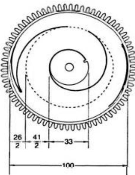
Slika 56. Omjeri promjera u kućištu bubnja [24]
