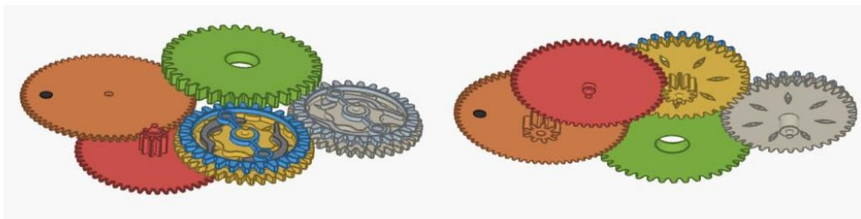
Slika 45. Zahvat svih zupčanika u mehanizmu automatskog navijanja [5]
