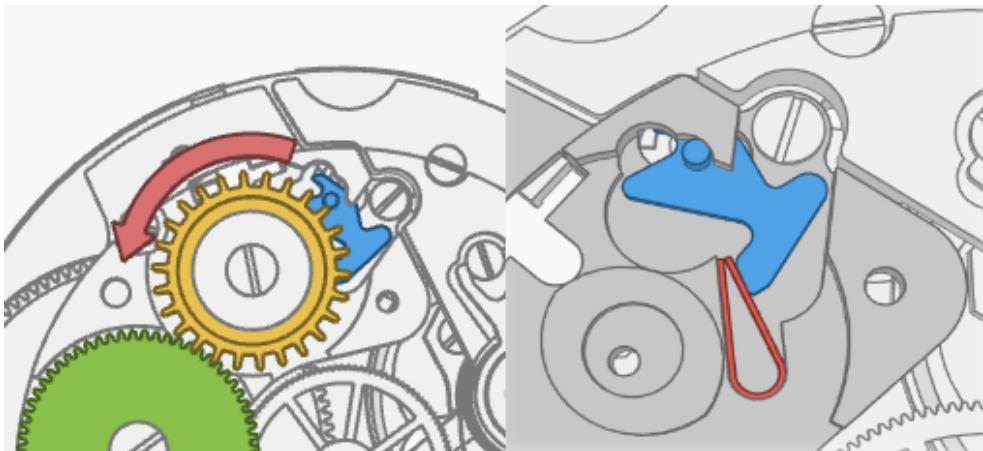
Slike 13. Zakret krunskog zupčanika u smjeru suprotnom smjeru kazaljke na satu [5]
