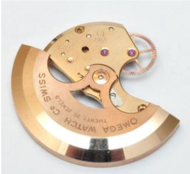
Slika 41. Mehanizam automatskog navijanja sata [21]
