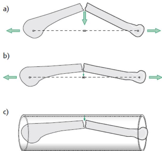
Slika 1. *Redukcija i stabilizacija frakture vlakom* [3]
