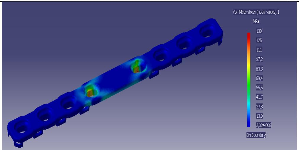
Slika 44. FEM Analiza naprezanja pločice u CATIA-i
