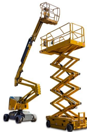
Slika 3. Radna platforma izvedena kao teleskopski stup i škarasti mehanizam.
