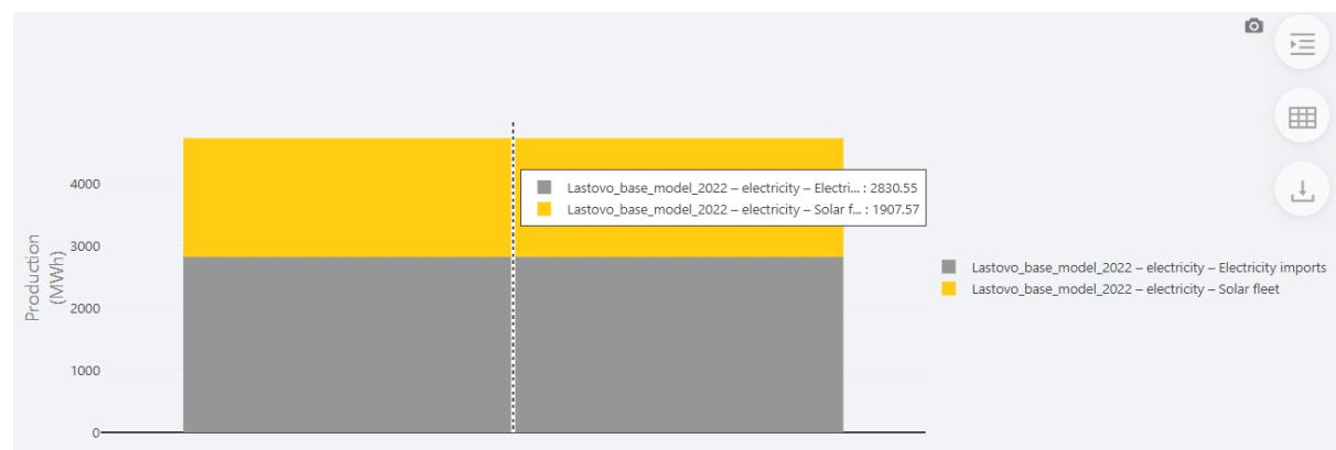
Slika 24. Energija proizvedena iz sunčane elektrane i uvoz energije za 2030. godinu
