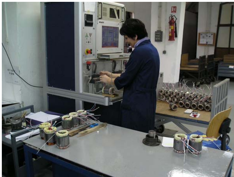
Slika 4.1 Uređaj za kontrolu u namataonici
