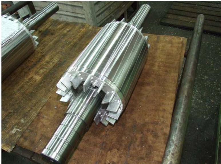
Slika 3.4 Sklop rotora i vratila
