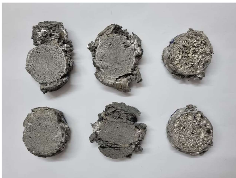
Slika 128 Uzorci nakon tlačnog ispitivanja
