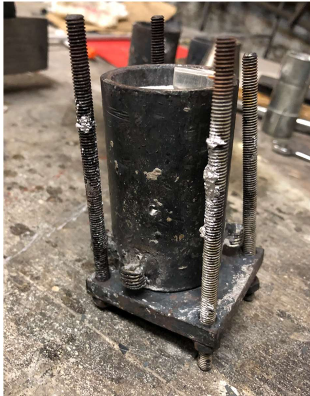
Slika 48 Kalup s prekursorom za izradu metalne pjene
