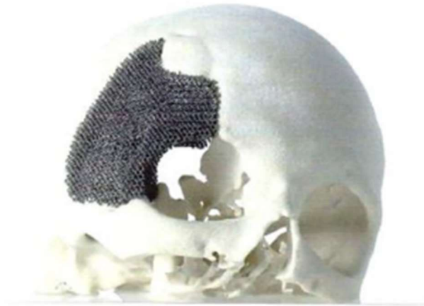
Slika 21 Prototip nadomjestka ljudske kosti od Ti-6Al-4V legure proizveden pomoću postupka taljenja snopom elektrona [12]
