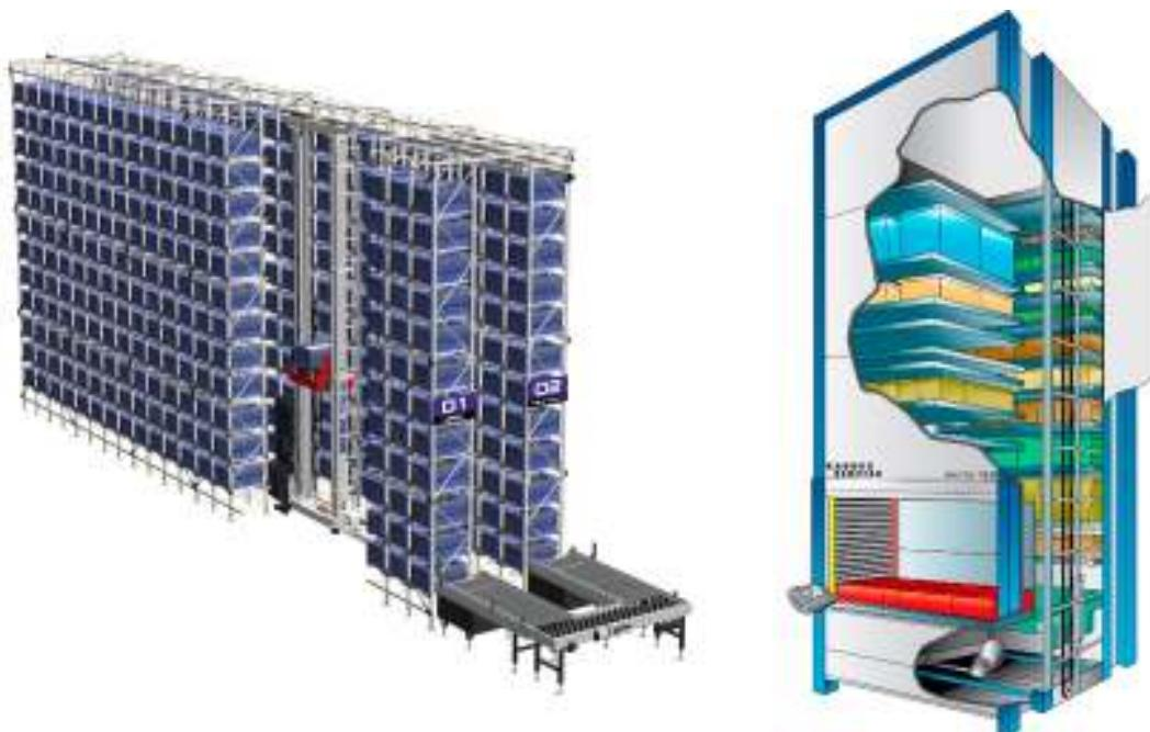
Slika 24. Usporedba mini-load AS/RS sustava i VLM-a [7], [8]
