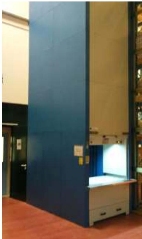
Slika 23. Instalirani vertikalni podizni modul
