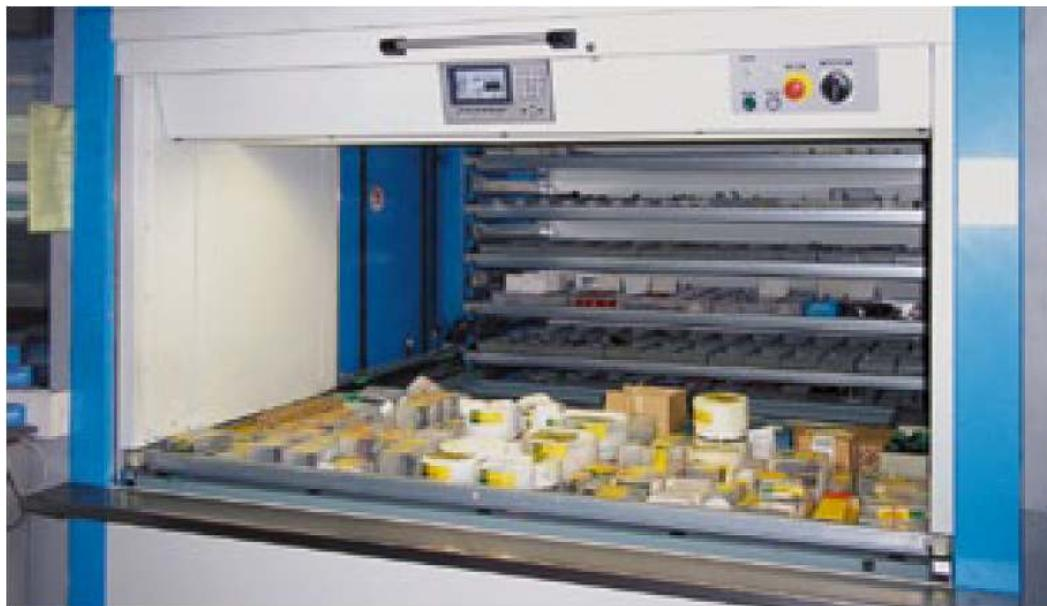
Slika 20. Radni otvor VLM-a s mjernim alatima TEH-CUT-a [9]
