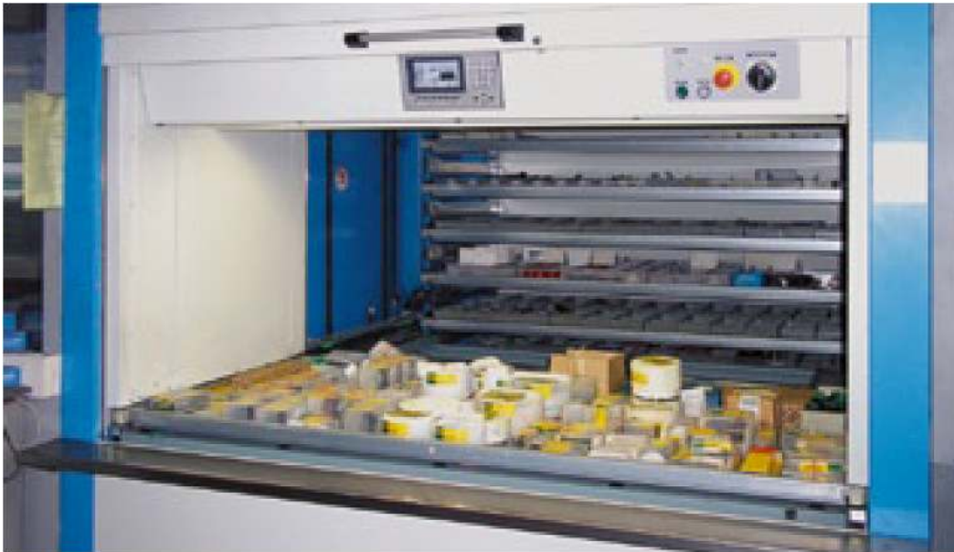
Slika 20. Radni otvor VLM-a s mjernim alatima TEH-CUT-a [9]
