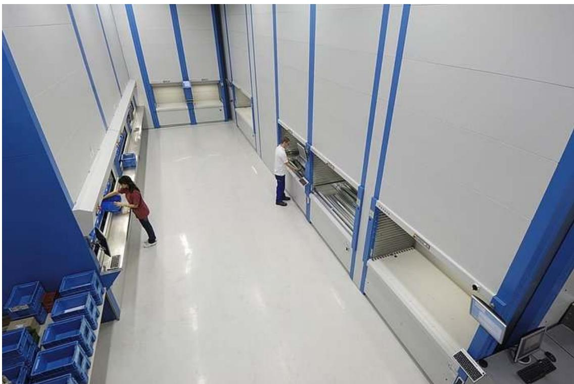
Slika 16. Sustav vertikalnih podiznih modula [8]
