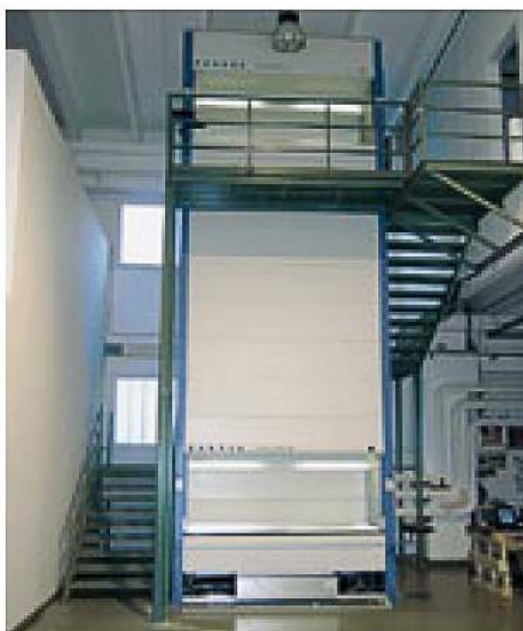
Slika 21. Podravka – instalirani VLM sa dva otvora [9]
