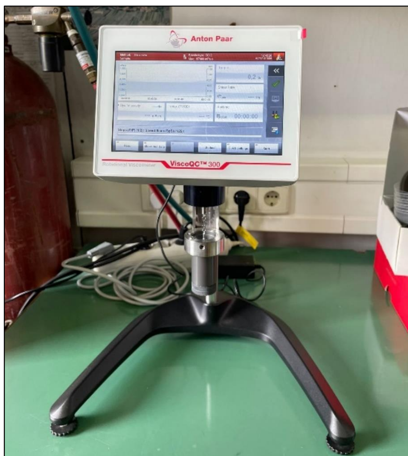
Slika 20. Viskozimetar – Anton Paar ViscoQC 300.
