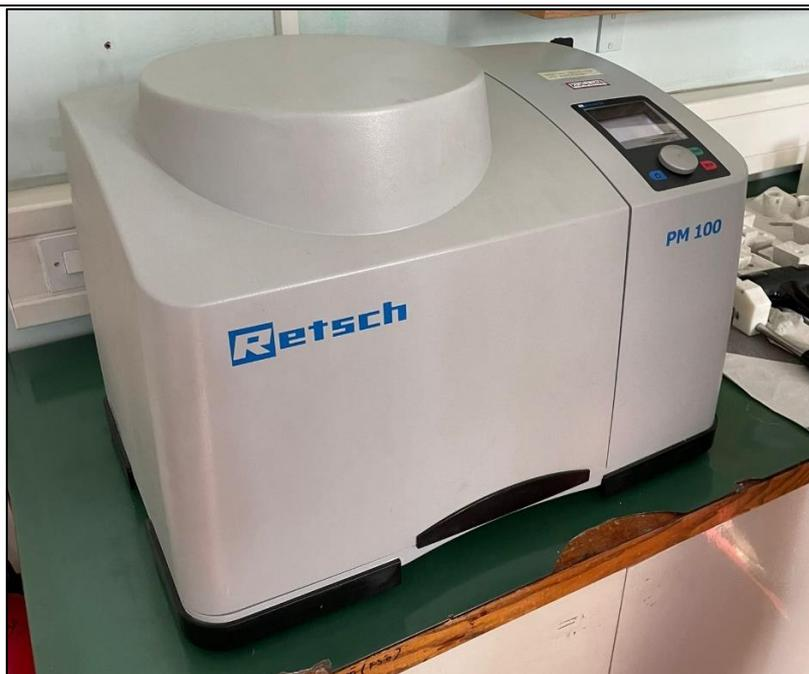
**Slika 19. Planetarni kuglični mlin (PM 100, Retsch GmbH, Njemačka).**
