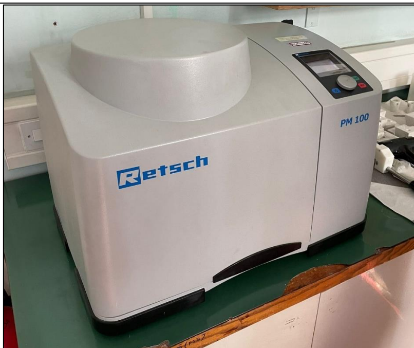
Slika 19. Planetarni kuglični mlin (PM 100, Retsch GmbH, Njemačka).
