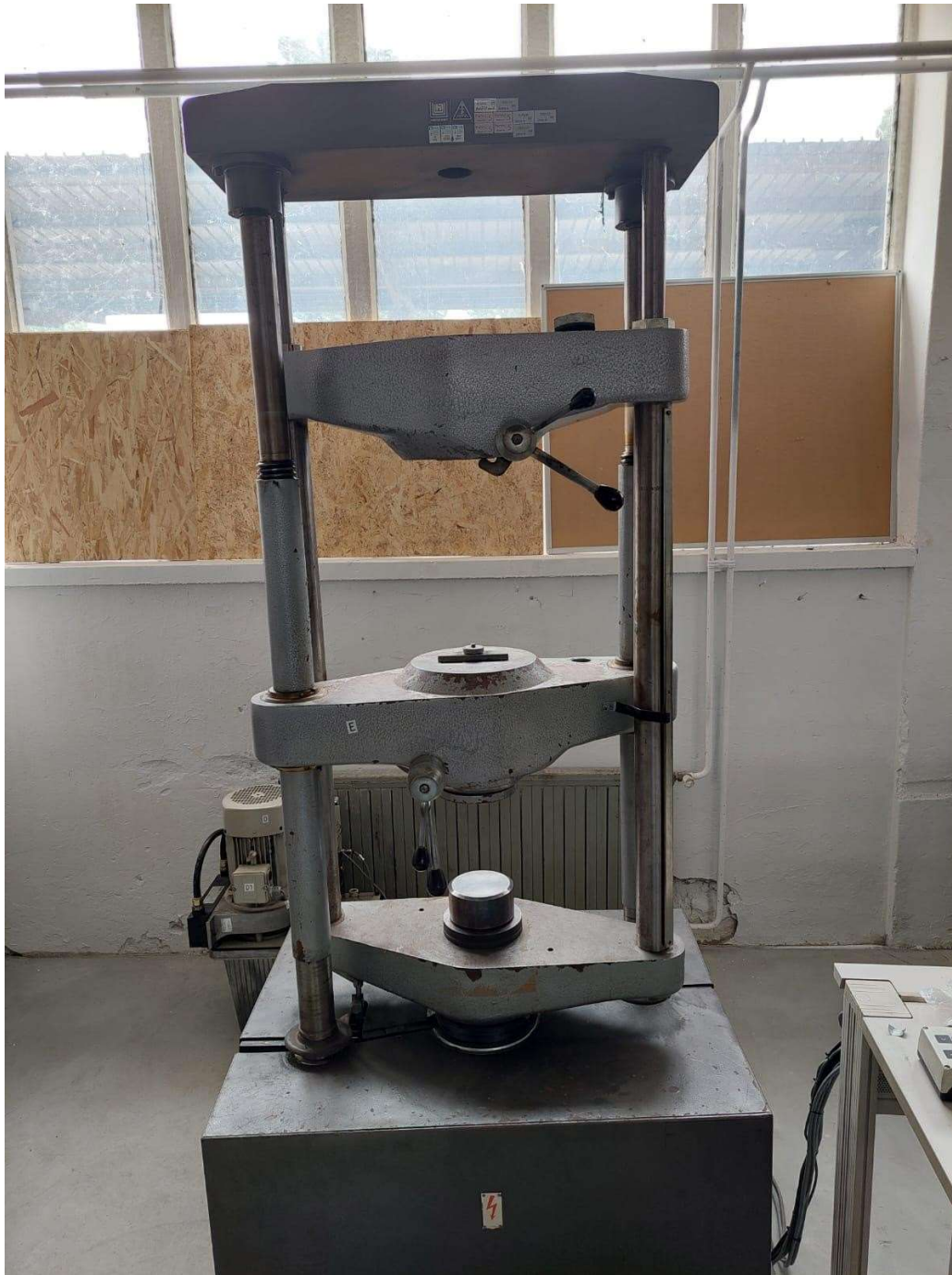
Slika 19. Uređaj za mjerenje tlačne čvrstoće
