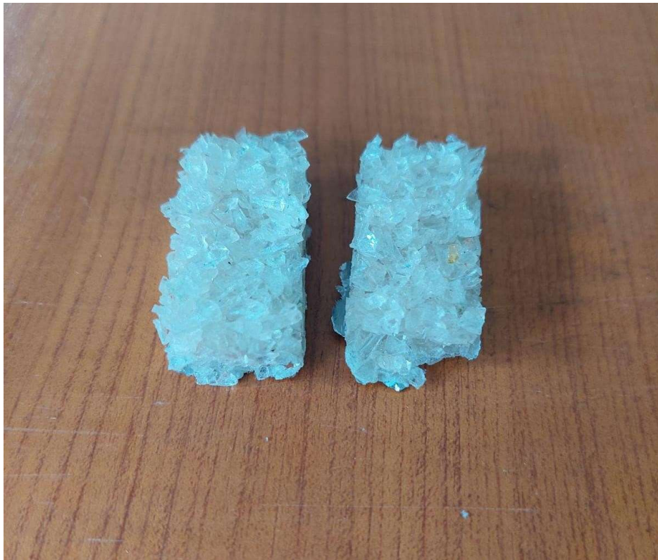
Slika 16. Ispitni uzorci izrađeni od recikliranoga stakla
