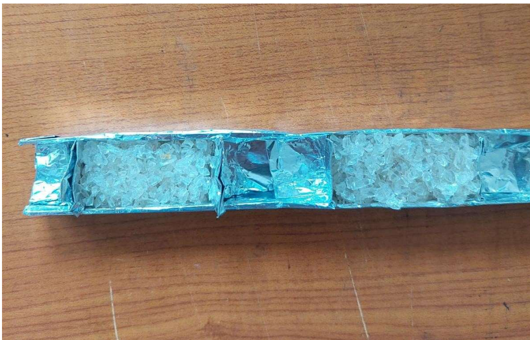
Slika 17. Ispitni uzorci u aluminijskom kalupu
