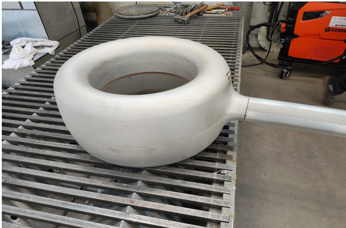
Slika 3.5 Toroidalna jezgra spremna za proces zavarivanja
