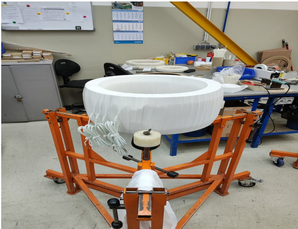
Slika 3.3 Namatanje sekundarnih namota
