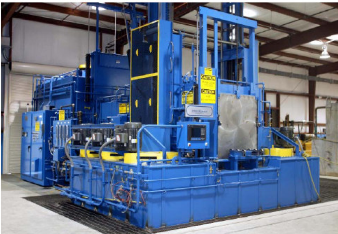
Slika 48. Industrijsko postrojenje za postupak intenzivnog gašenja [25]
