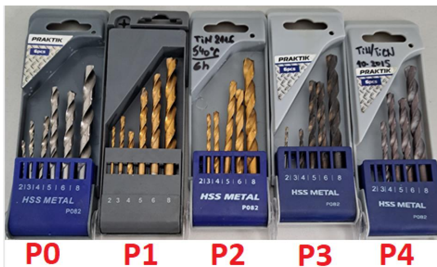
Slika 25. Svrkla u polaznom stanju prije pokusa trošenja
