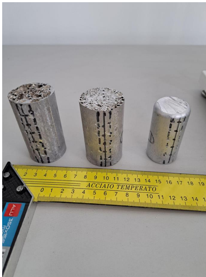
Slika 27. Uzorci predviđeni za ispitivanje svrdla
