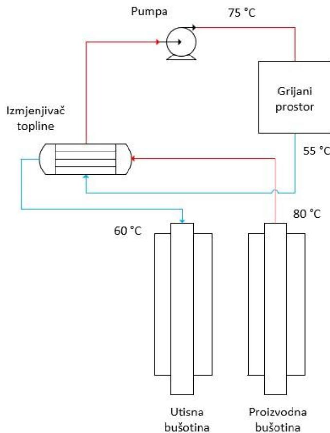
Slika 6. Pojednostavljeni prikaz sustava za grijanje prostora
