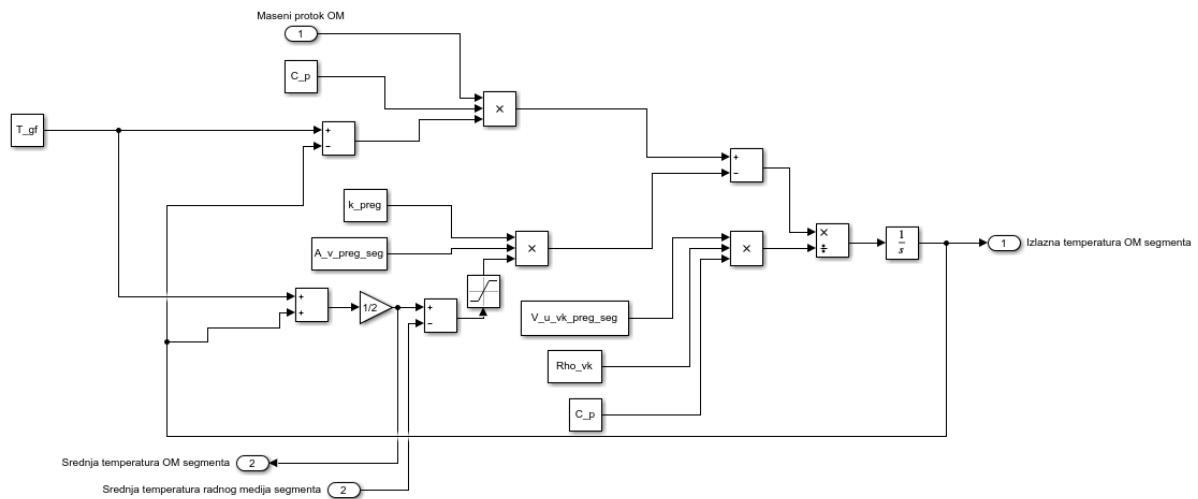
Slika 41. Izračun izlazne temperature segmenta ogrijevnog medija – pregrijač
