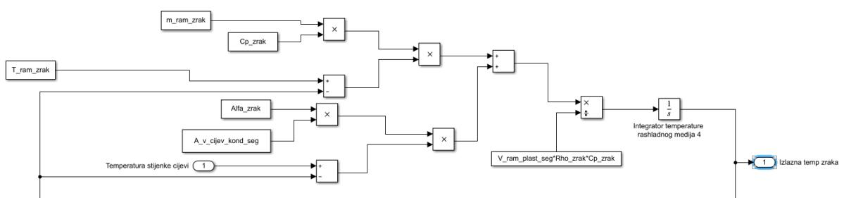
Slika 43. Izračun temperature rashladnog medija segmenta – kondenzator
