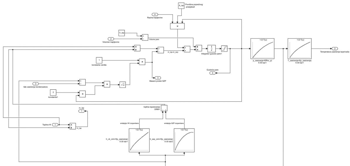
Slika 39. Simulink model izračuna parametara suhozasićene pare – isparivač
