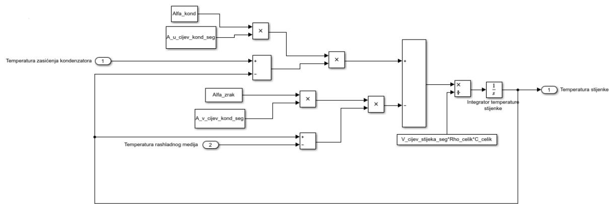
Slika 44. Izračun temperature stijenke cijevi segmenta – kondenzator
