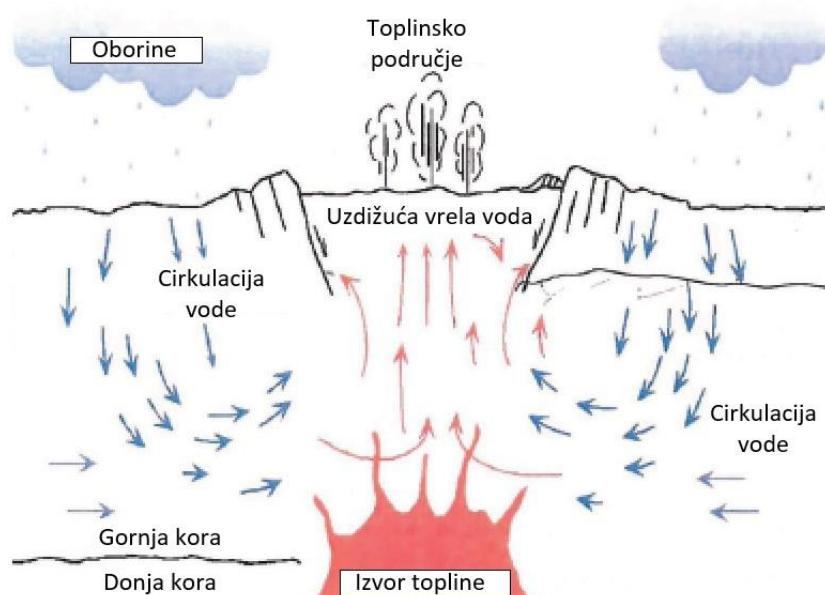
Slika 3. Geotermalni sustav s većinskim udjelom kapljevine [7]
