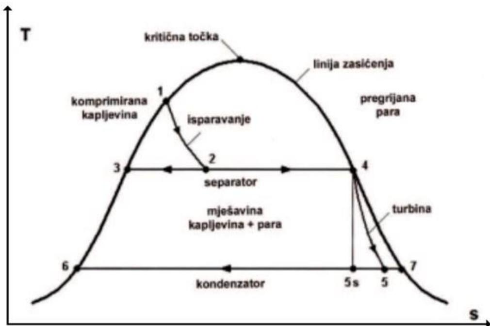
Slika 10. Prikaz T-s dijagrama procesa s jednostrukim isparavanjem [13]
