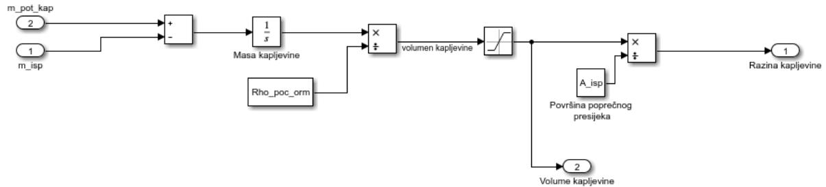
Slika 38. Simulink model izračuna volumena i razine kapljevine - isparivač
