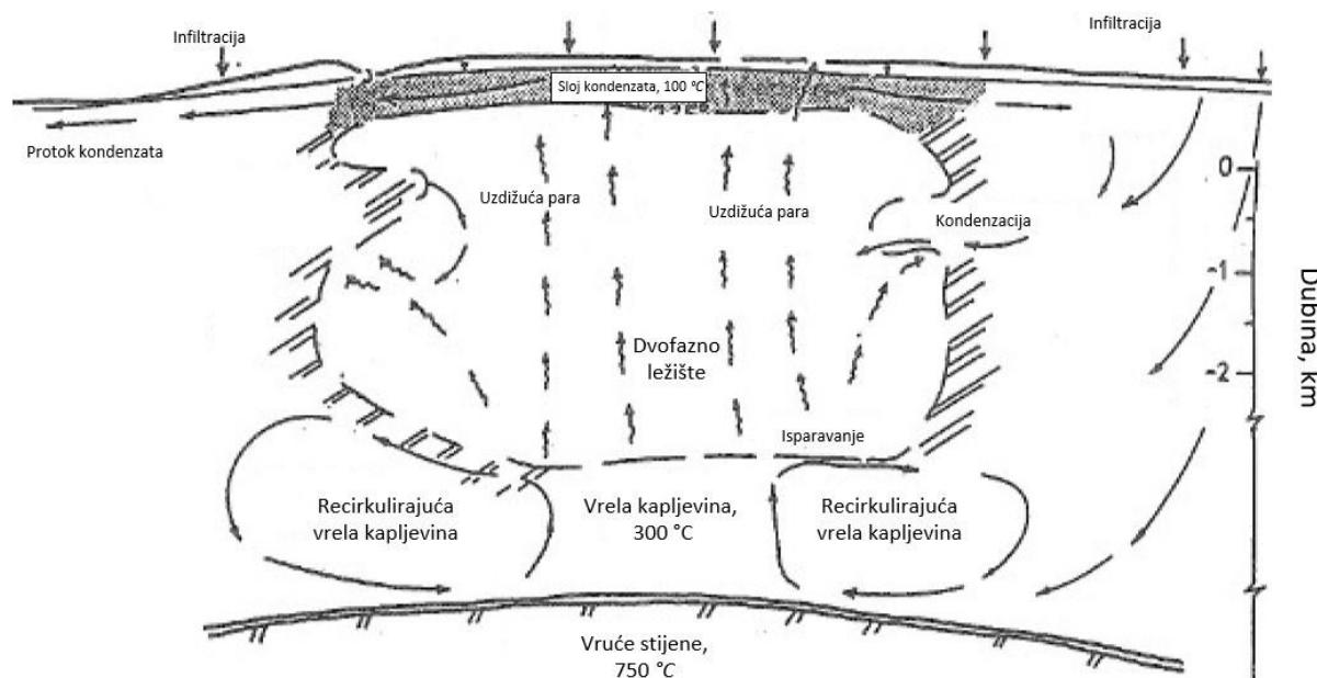
Slika 4. Geotermalni sustav s većinskim udjelom pare [4]
