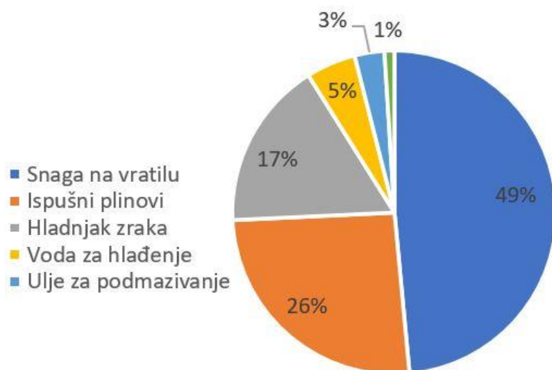
Slika 2 Distribucija energije tipičnog broskog porivnog motora [3]
