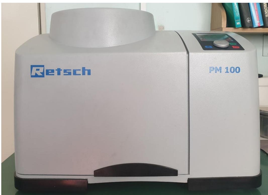
Slika 31. Planetarni kuglični mlin
