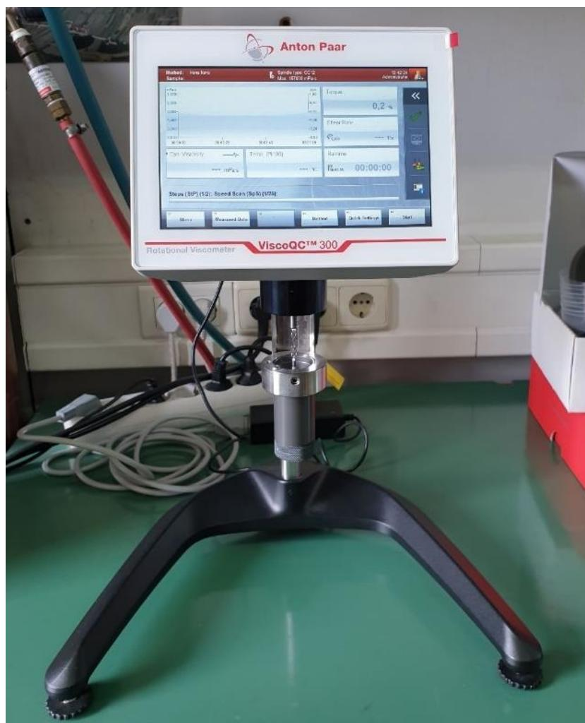
Slika 32. Rotacijski viskozimetar
