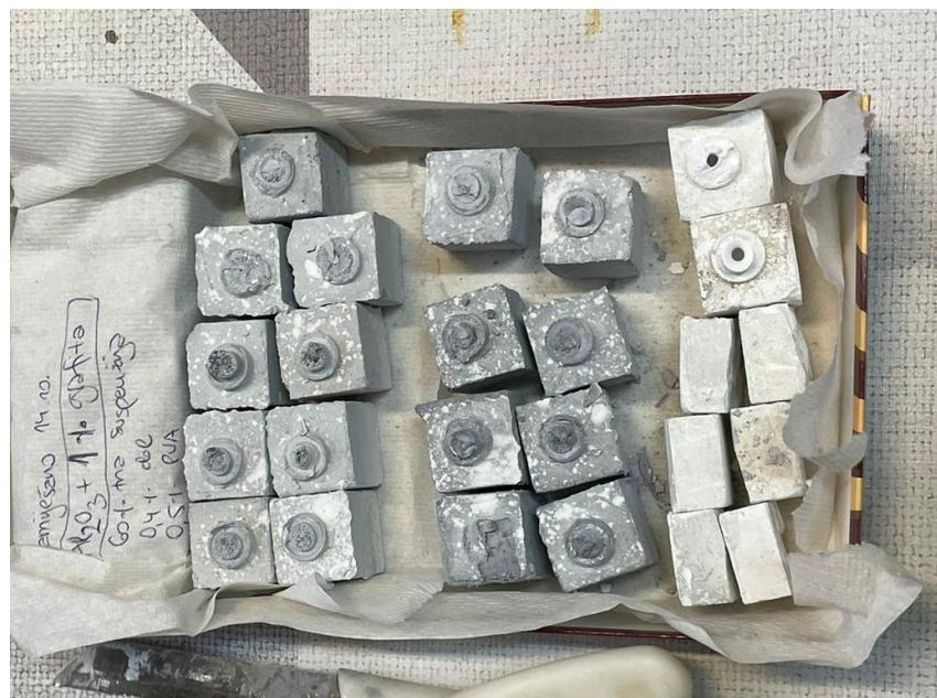
Slika 33. Keramički sirovci prije obrade
