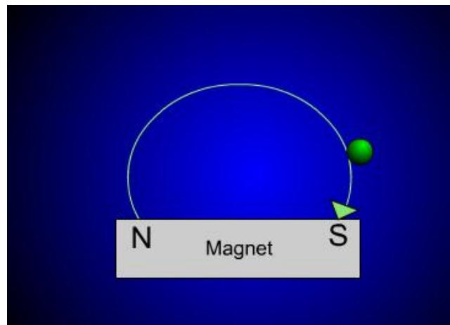
**Slika 23: Fizikalni princip zadržavanja sekundarnih elektrona u području mete pomoću magnetskog polja [8]**
