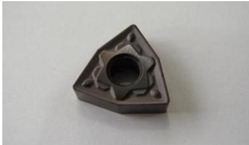
Slika 68: Rezna pločica prevučena  $\text{Al}_2\text{O}_3$  prevlakom [31]
