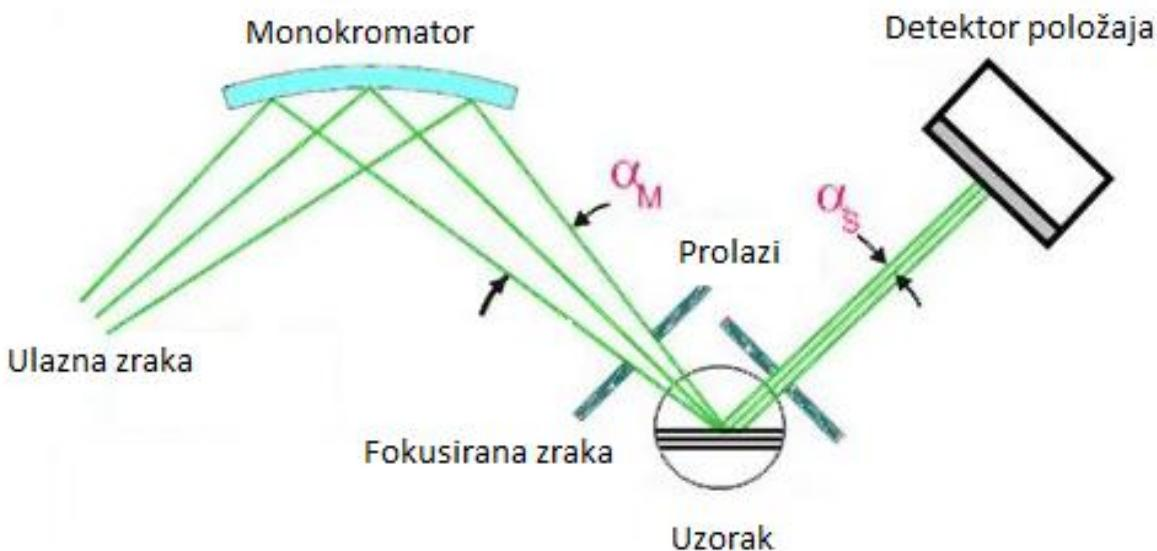
Slika 55: Shematski prikaz ispitivanja zaostalih naprezanja u prevlaci neutronskom difrakcijom [24]
