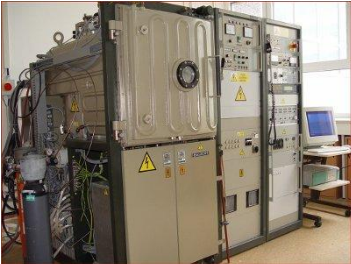
Slika 30: IBAD sustav Češkog tehničkog sveučilišta u Pragu [11]
