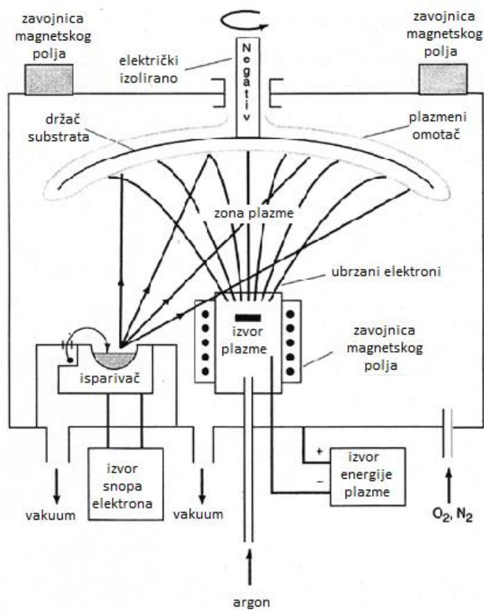
Slika 33: Shematski prikaz modernijeg sustava za ionsko platiniranje [3]
