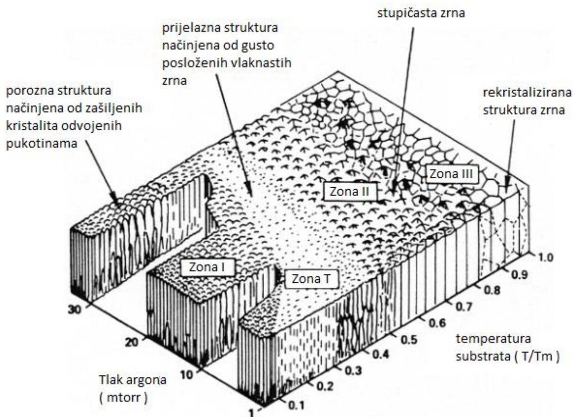
Slika 7: Thornton-ov "strukturno-zonski" model s osnovnim zonama rasta prevlake [3]
