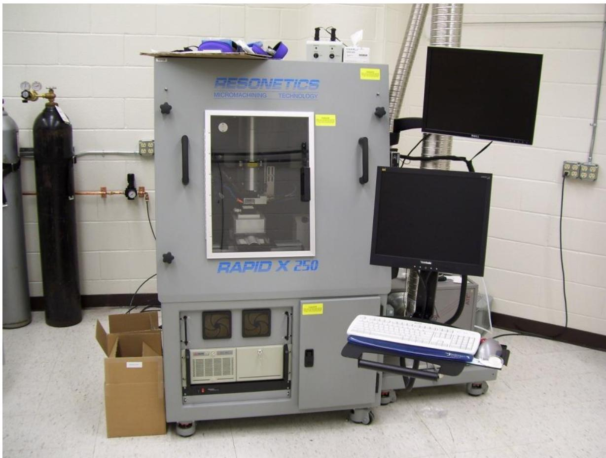
**Slika 11: Uredaj sa dva izvora materijala prevlake sa elektrootpornim grijanjem Zavoda za kemiju, Sveučilišta u Georgiji [7]**
