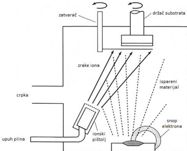
Slika 32: Shematski prikaz sustava za vakuumsko ionsko platiniranje [3]
