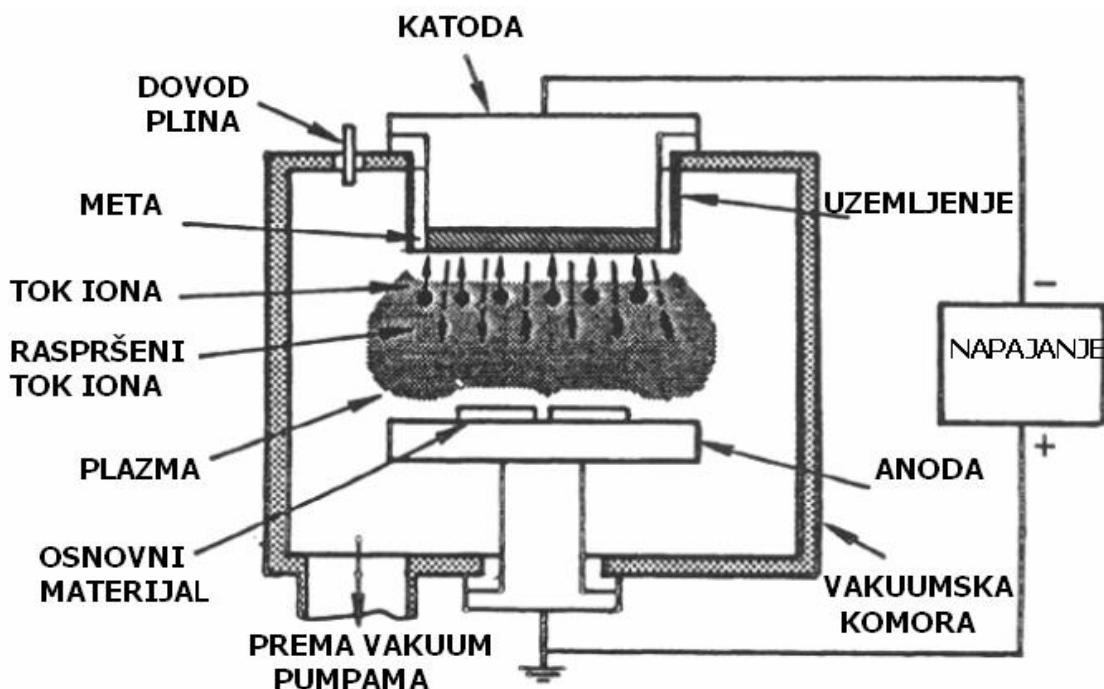
Slika 19: Shematski prikaz PVD postupka raspršivanja materijala prevlake planarnom diodom [2]
