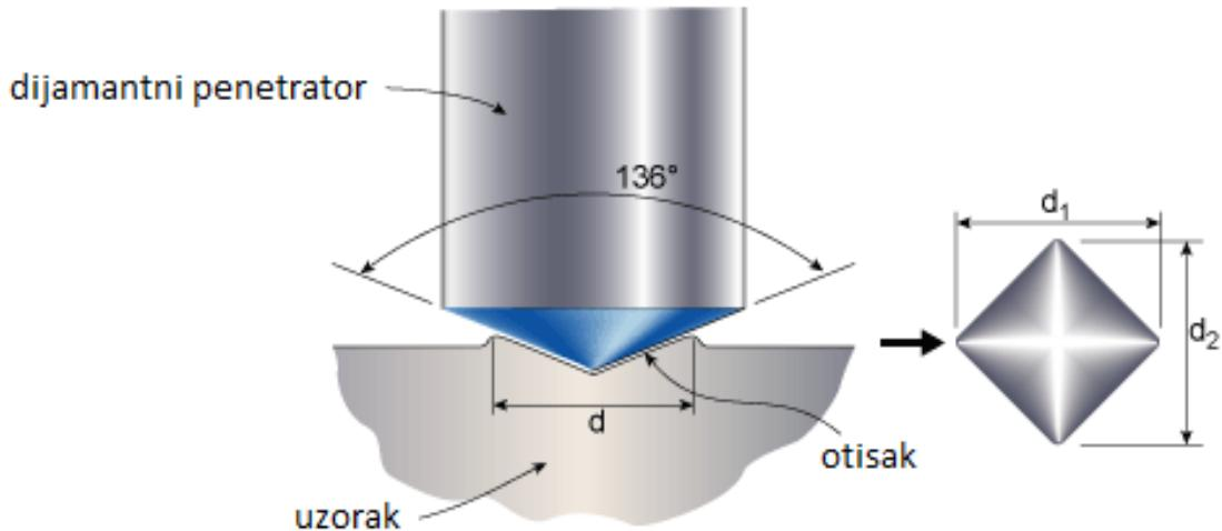
Slika 46: Princip mjerena mikrotvrdoće prevlake Vickers-ovom metodom [20]
