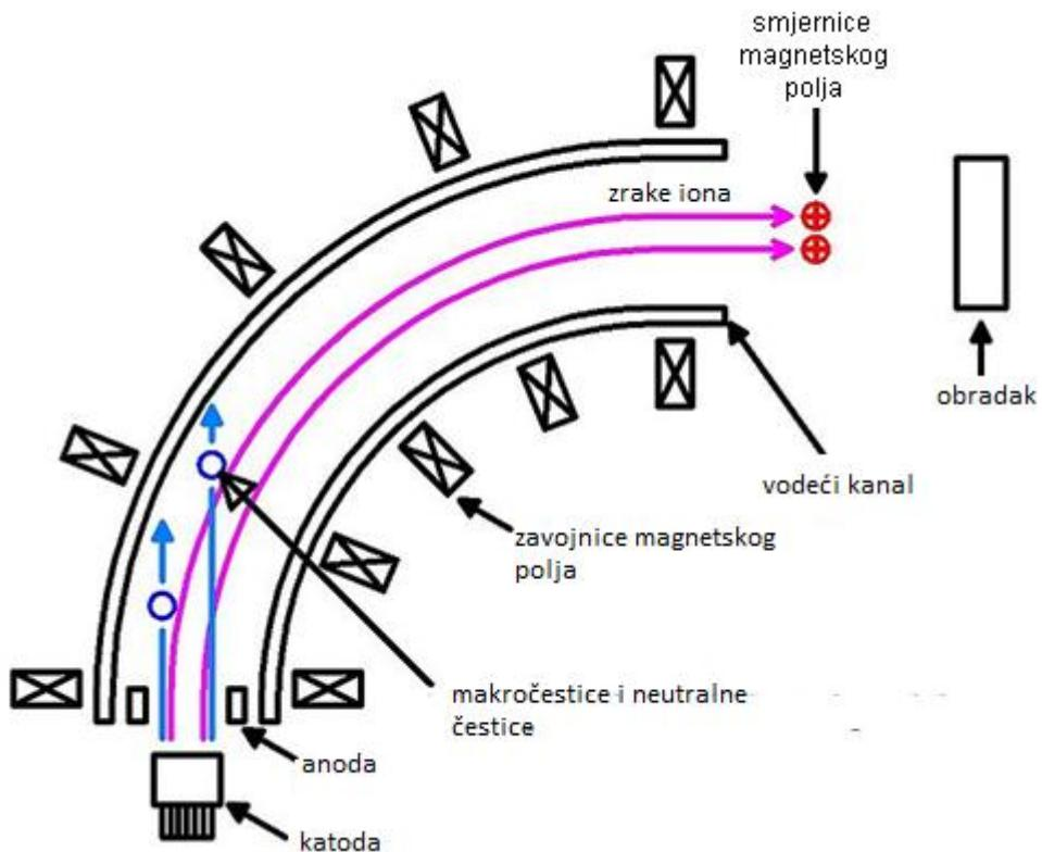
Slika 36: Aksenov-Ijev četverojezgreni filter makročestica [5]
