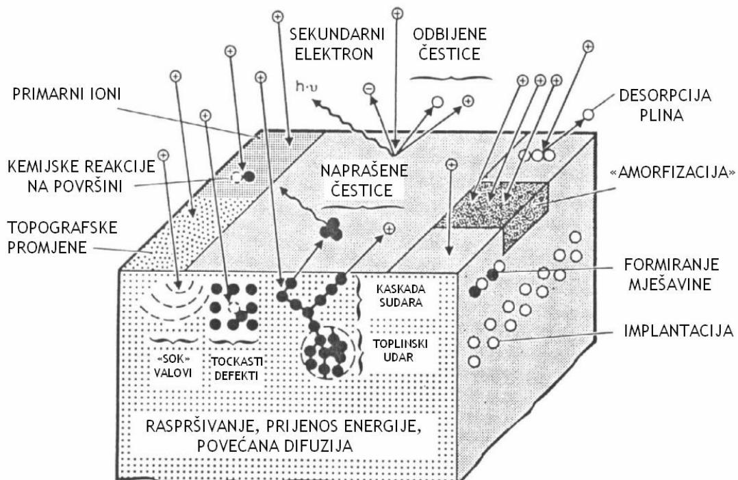
Slika 5: Osnovni fizikalni procesi pri raspršivanju materijala prevlake [3]
