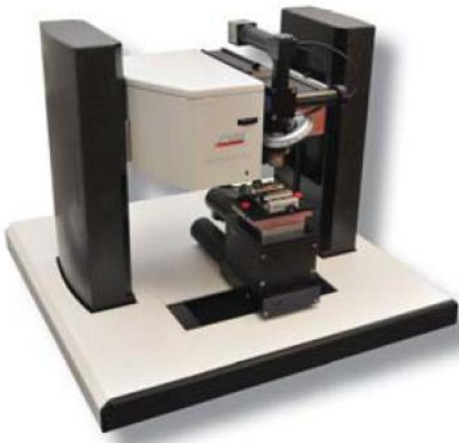
**Slika 54: Uređaj za ispitivanje adhezije prevlake na substrat brazdanjem tvrtke CSM, model Micro Scratch Tester [22]**
