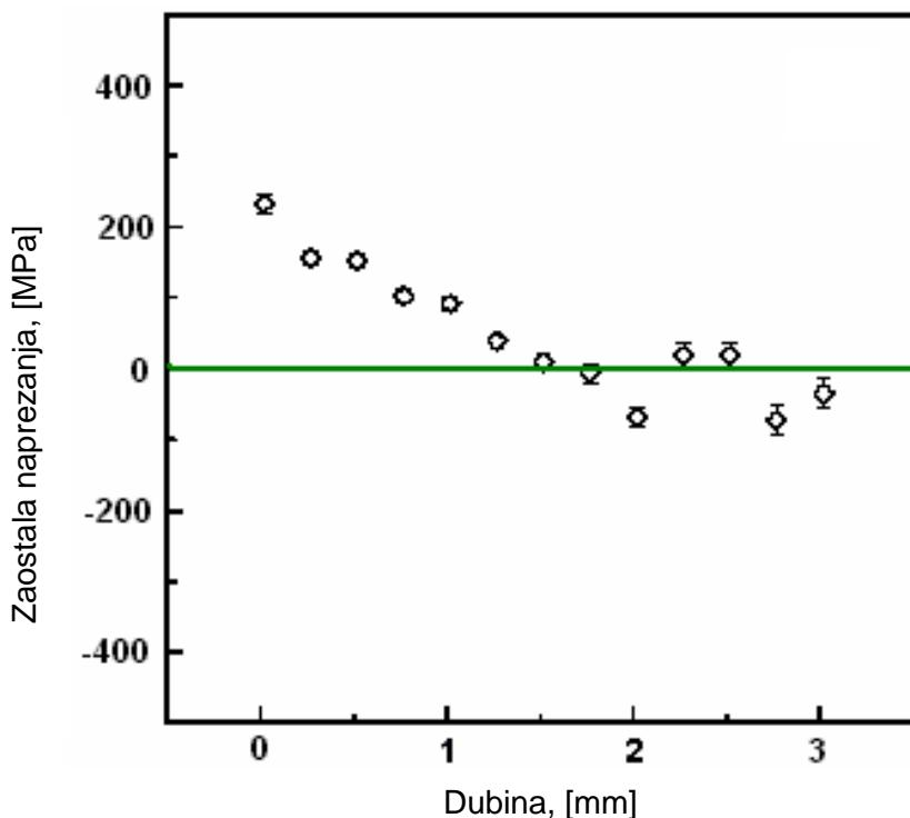
Slika 56: Rezultati ispitivanja zaostalih naprezanja neutronskom difrakcijom WC prevlake na 13CrNi4 slitini, provedenog u Rogante Engineering Office [24]
