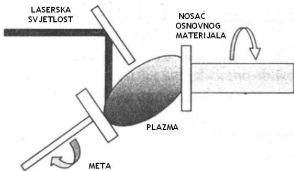
Slika 14: Shema uređaja za PVD postupak pulsnog laserskog nanošenja prevlake [2]
