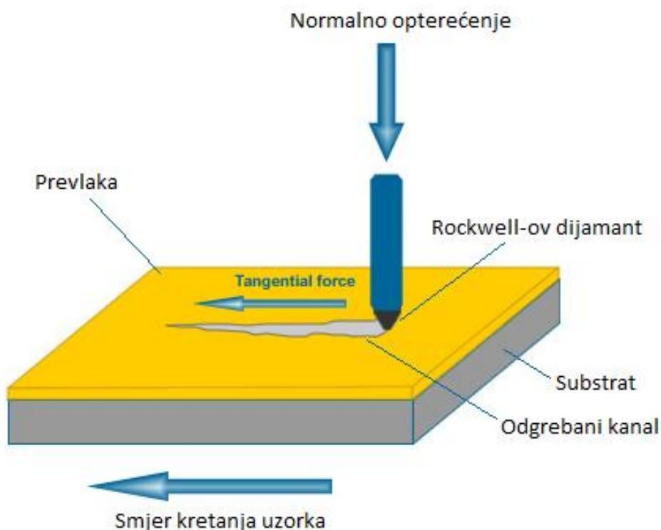
Slika 50: Princip ispitivanja adhezije prevlake na substrat brazdanjem [8]
