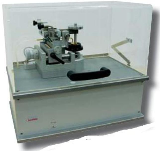
**Slika 58:** Standardni tribometar koji radi na principu pin-on-disc tvrtke CSM [22]
