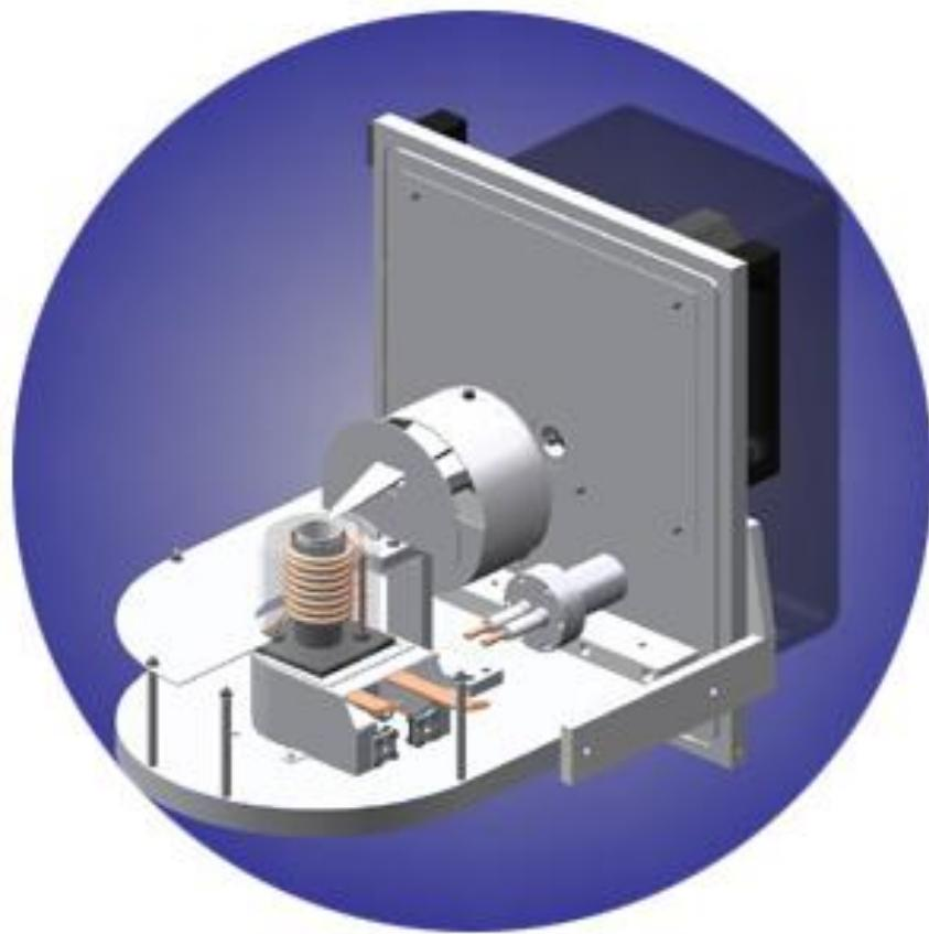
Slika 13: Isparivač materijala prevlake sa indukcijskim grijanjem [6]
