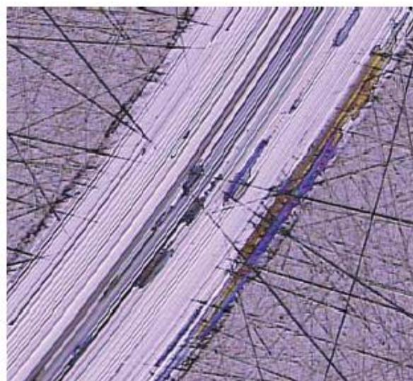
**Slika 59:** Izgled površine uzorka nakon ispitivanja triboloških svojstava pin-on-disc metodom [22]
