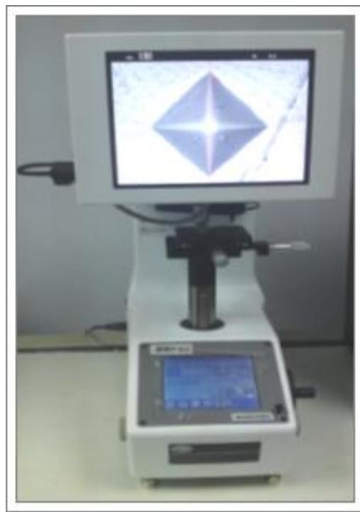
Slika 47: Uređaj za mjereno mikrotvrdoće prevlake Vickers-ovom metodom [21]
