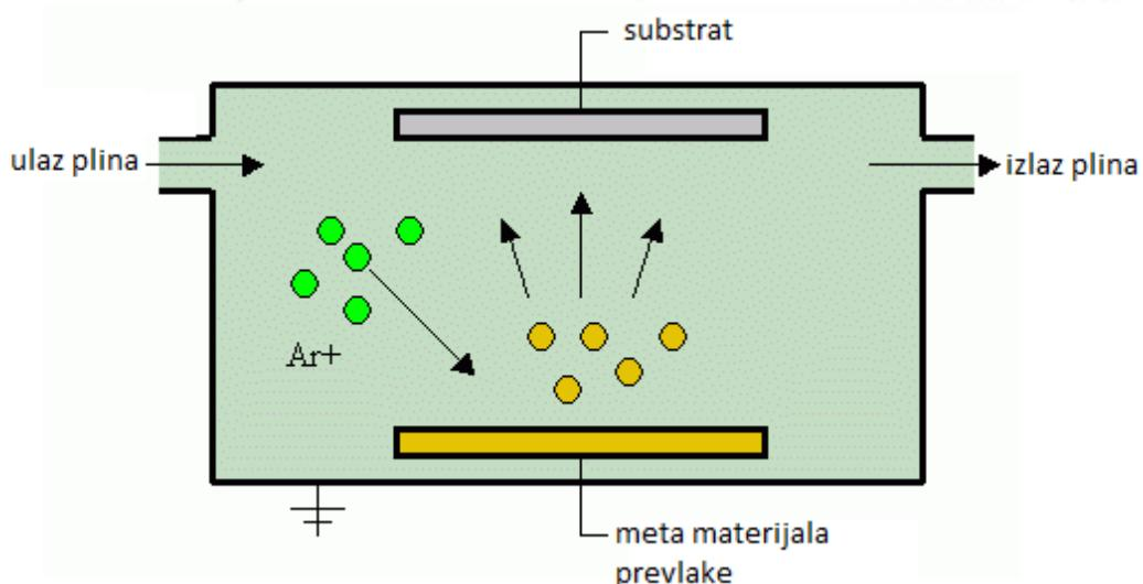
Slika 18: Osnovni fizikalni princip raspršivanja materijala prevlake iz mete [5]
