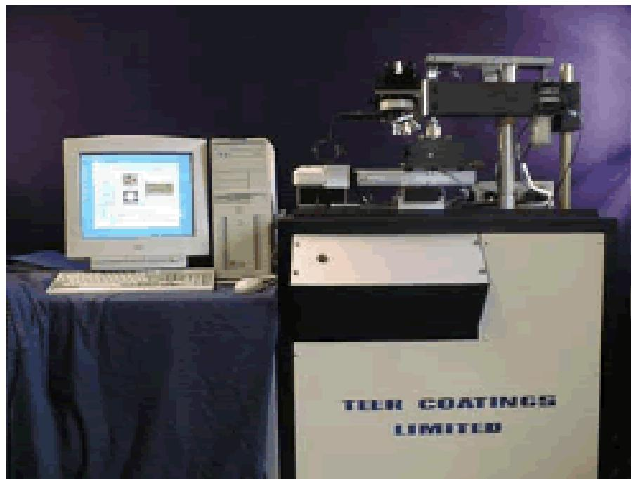
Slika 51: Sustav za ispitivanje adhezije prevlake na substrat brazdanjem [8]
