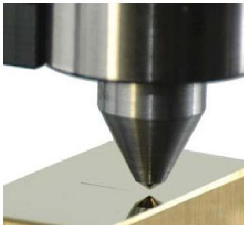
**Slika 53: Glava modernog uređaja sa penetratorom za ispitivanje adhezije prevlake na substrat brazdanjem [22]**
