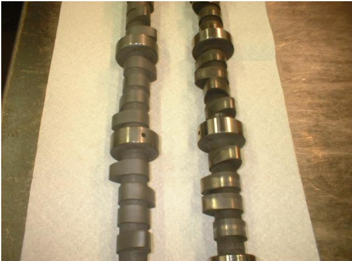
**Slika 66: Bregasta osovina i-Vtec motora tvrte Honda sa bregovima prevučenim prevlakom MoST [5]**
