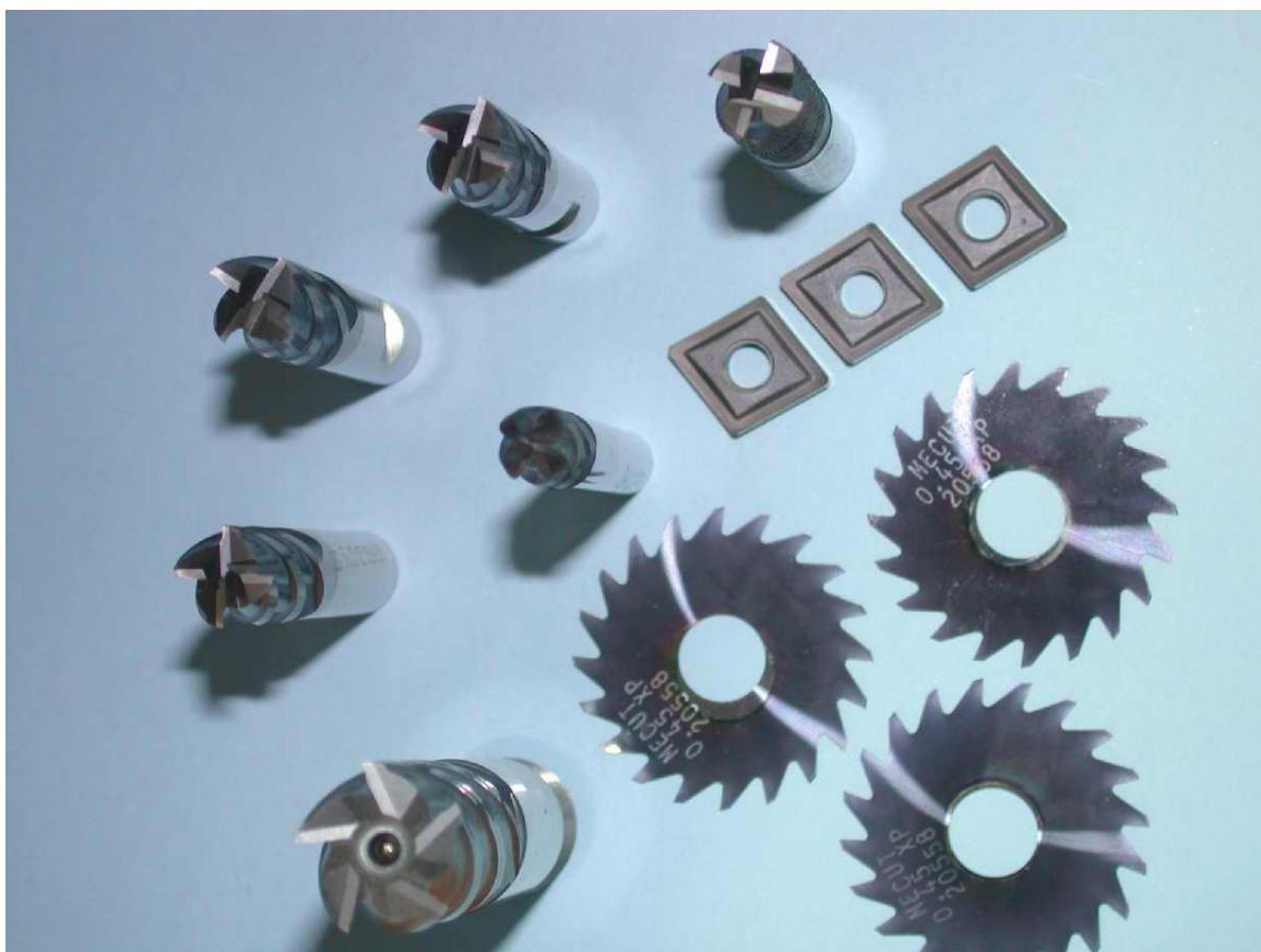
Slika 63: Prikaz reznih alata prevučeni (Ti,Al)N prevlakom [27]
