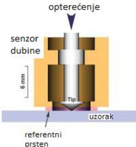
Slika 48: Princip rada suvremenih mikrotvrdomjera [22]
