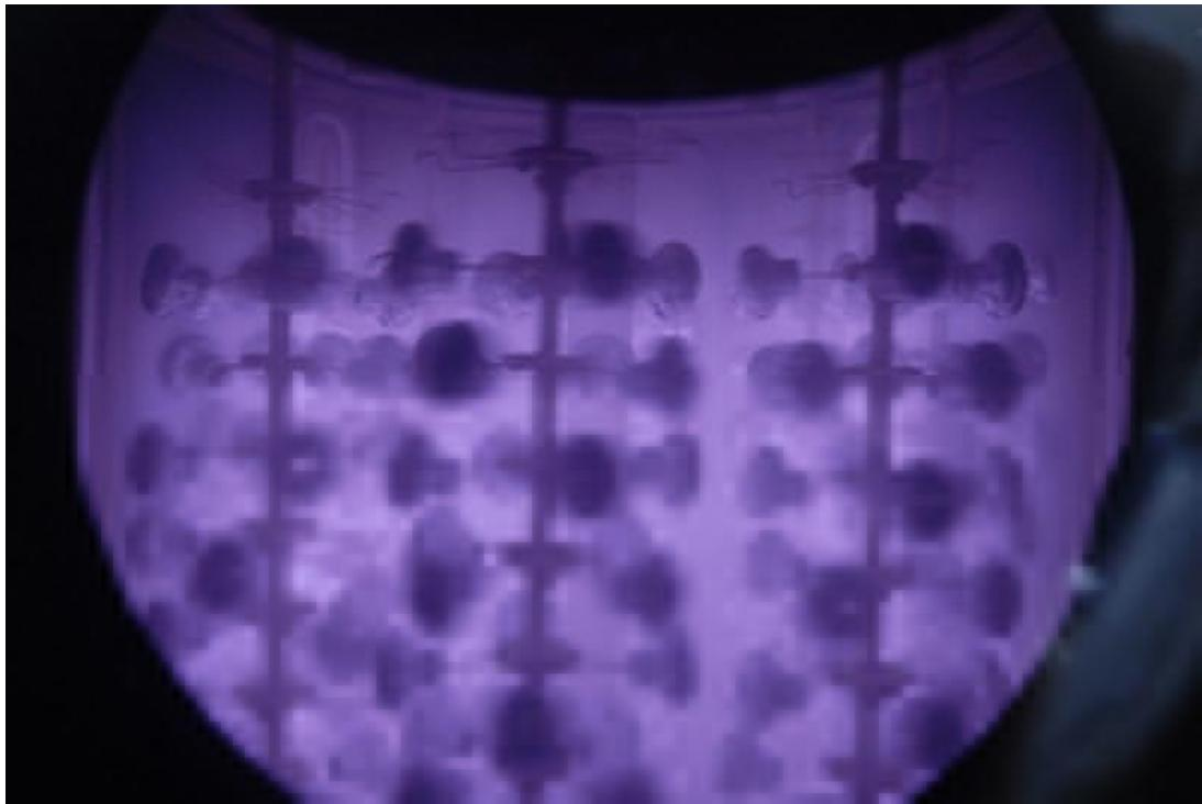
Slika 6: Prikaz unutrašnjosti komore u kojoj su obratci okruženi plazmom koja prenosi materijal prevlake [4]
