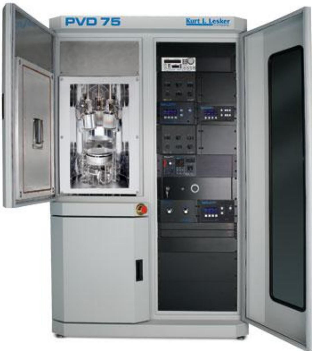
Slika 20: Uredaj za PVD postupak raspršivnja materijala prevlake planarnom diodom, model PVD 75, tvrtke Kurt J. Lesker [6]
