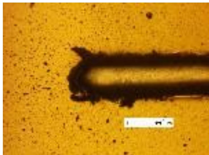
Slika 52: Izgredbani kanal nakon ispitivanja brazdanjem na prevlaci TiN dobivenoj PVD postupkom s magnetskim raspršivanjem materijala prevlake [8]
