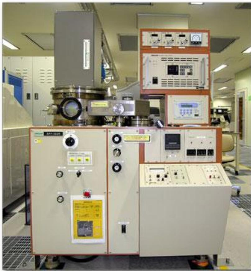
**Slika 22: Uređaj za PVD postupak r-f raspršivanja materijala mete tvrtke Anelva, model SPF-332H [7]**
