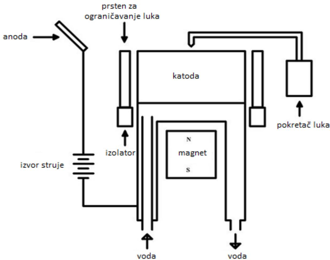
Slika 35: Shematski prikaz principa elektrolučnog taložena prevlake [5]
