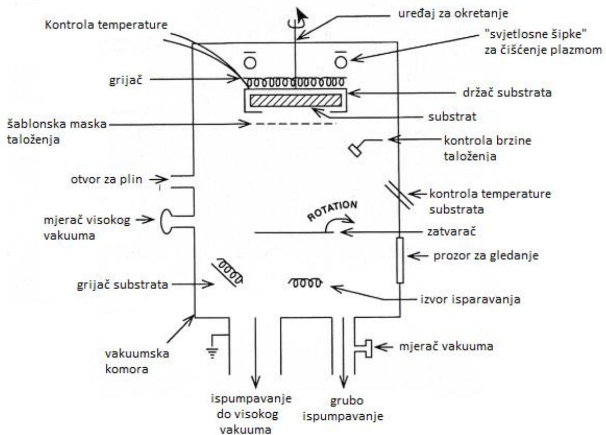
Slika 1: Shematski prikaz uređaja za isparivanje materijala prevlake [3]
