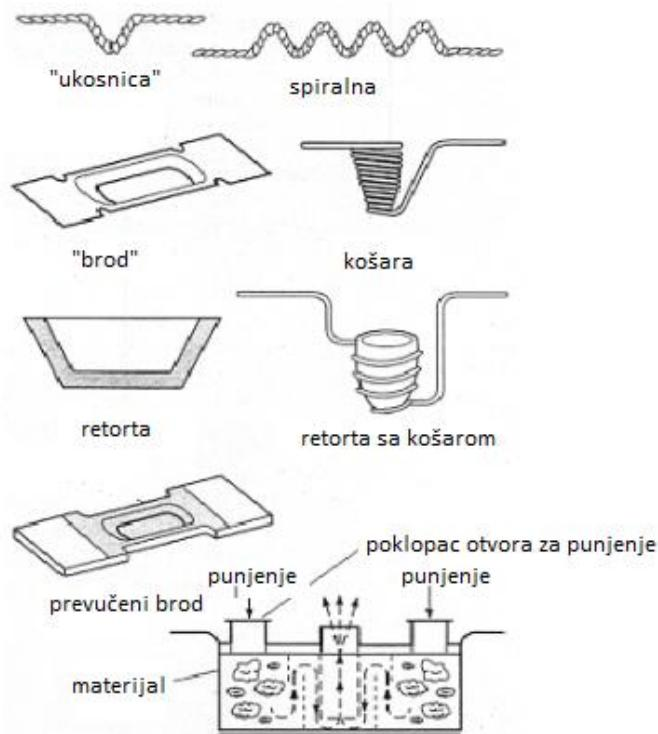
**Slika 9:** Uobičajeni oblici žarnih niti i izvora materijala prevlake grijanih električnim otporom [3]
