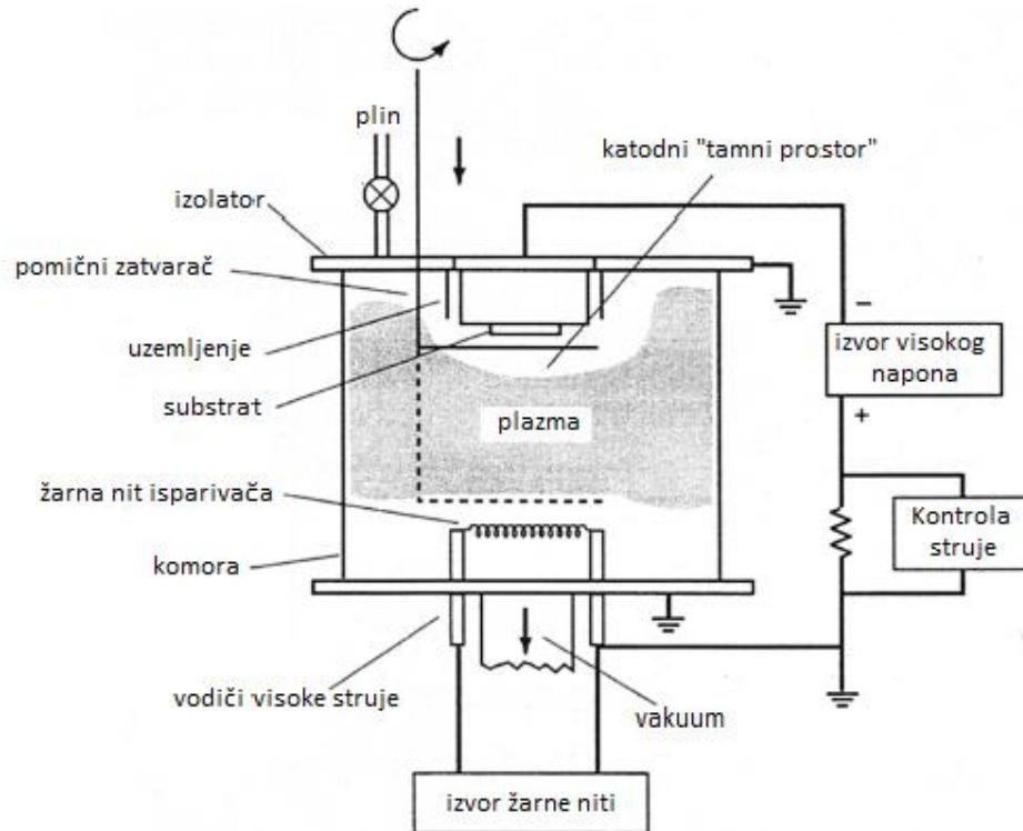
Slika 31: Shematski prikaz sustava plazmatskog ionskog platiniranja [3]
