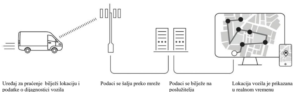
**Slika 21. Telematski sustav [35]**
