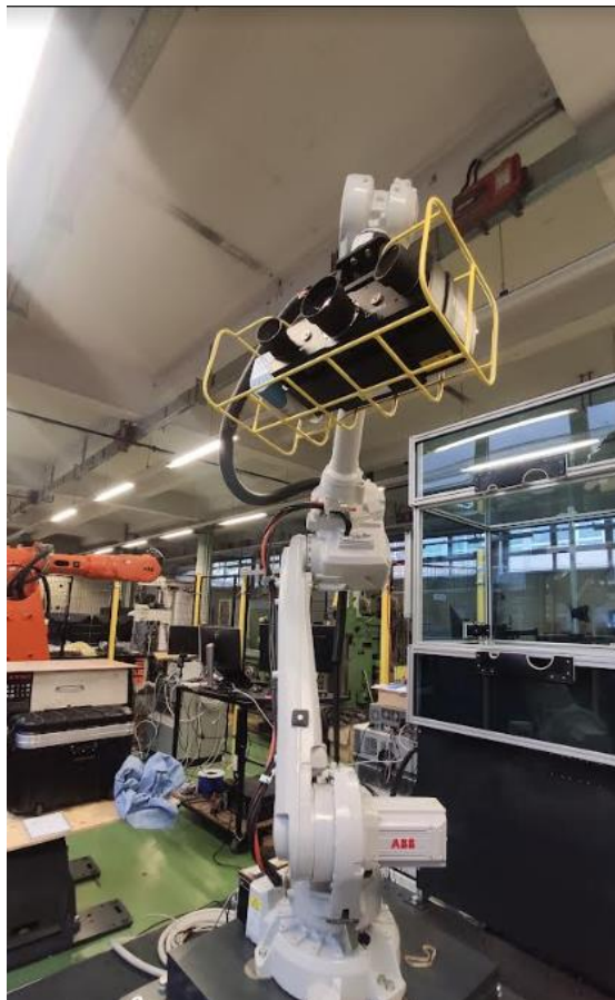
Slika 7 ABB IRB4600 s mjernim uređajem Atos 5X
