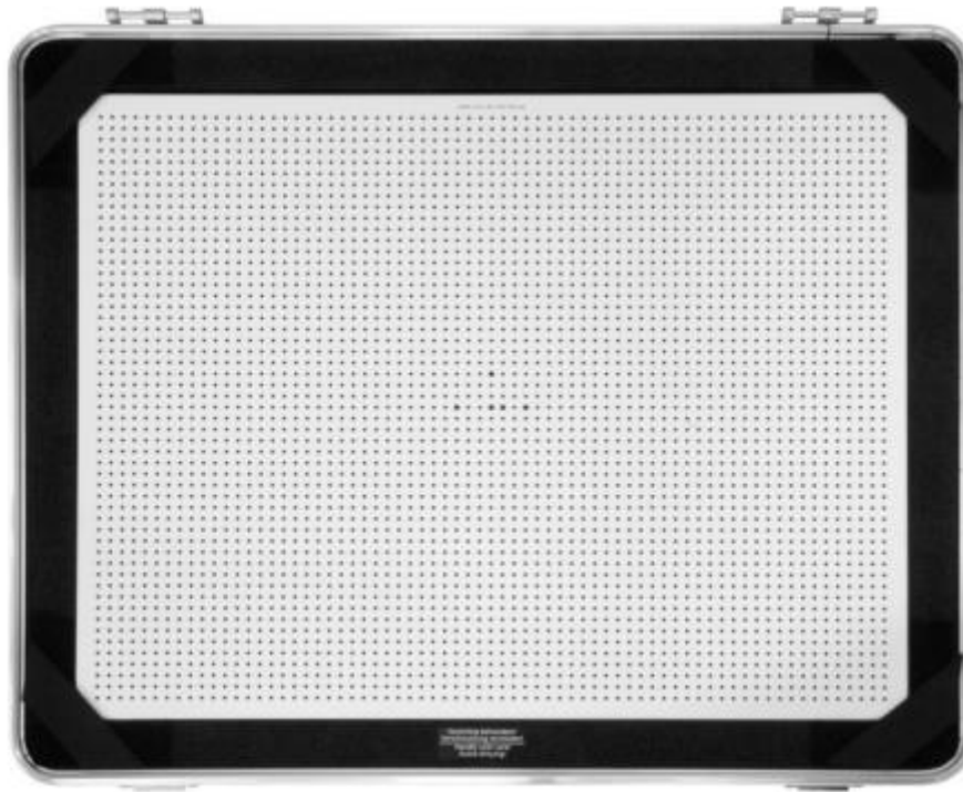
Slika 4 Kalibracijska ploča MV500[1]
