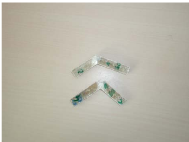
Slika 25. Epruvete sa zarezom koje su otvrdnjavale pri 60°C, potpuni lom
