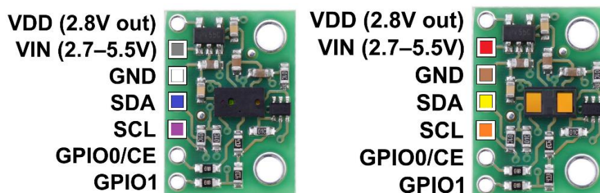
Slika 25. VL6180X [26] (lijevo) i VL53L1X [27] (desno), senzori vremena preleta
