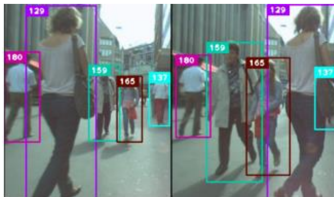
Slika 31. Identifikacijski brojevi korištenjem DeepSORT algoritma [50]
