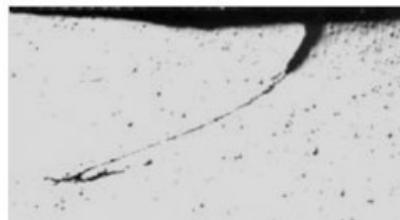
Pukotine na vanjskoj površini zbog nečistoća u čeliku
