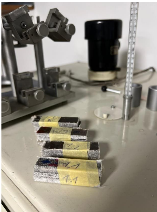
Slika 31. Uzorci pripremljeni za Martens postupak ispitivanja
