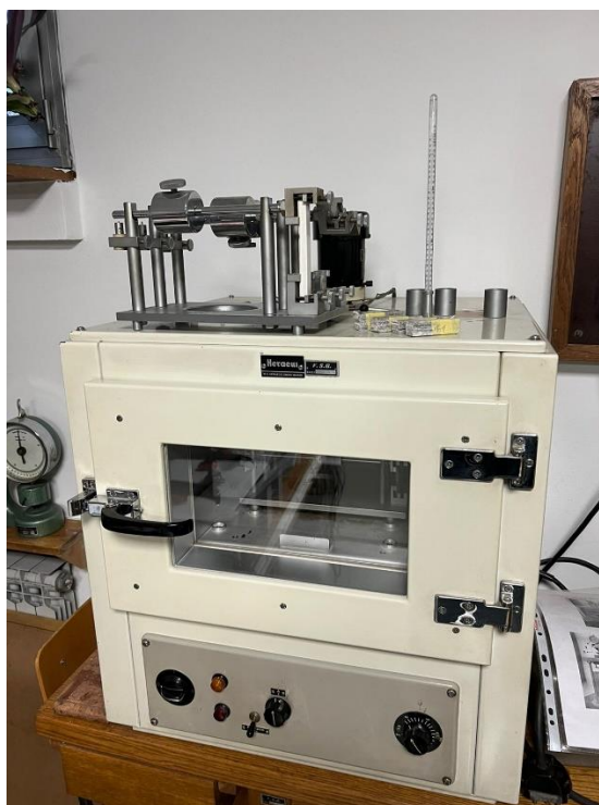
Slika 32. Uređaj za provedbu Martens ispitivanja
