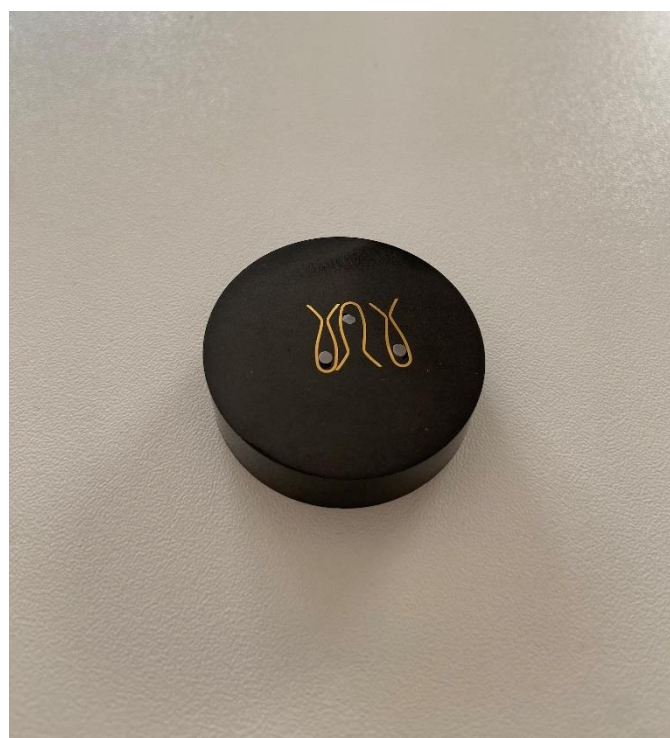
Slika 20. Uzorci pripremljeni za EDS analizu zaliveni u polimernu masu
