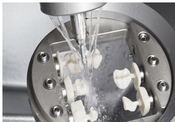
Slika 7. Postupak mokrog glodanja [22]
