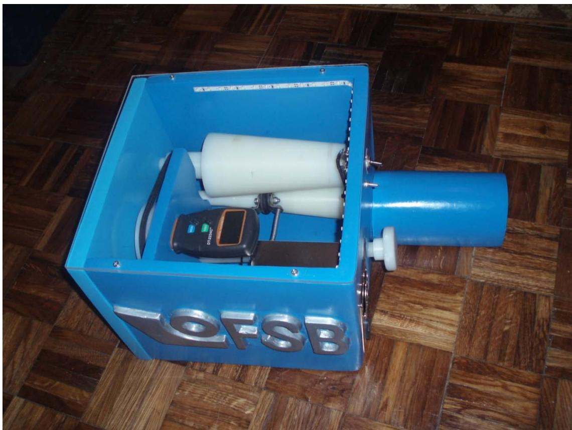
Slika 4.12. Prototip reduktora
