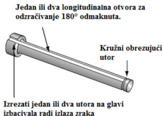
Slika 27. Primjer kanala za odzračivanje na izbacivalu [6]
