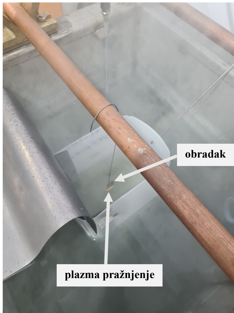
Slika 16. Postupak elektrolitičkog-plazma poliranja
