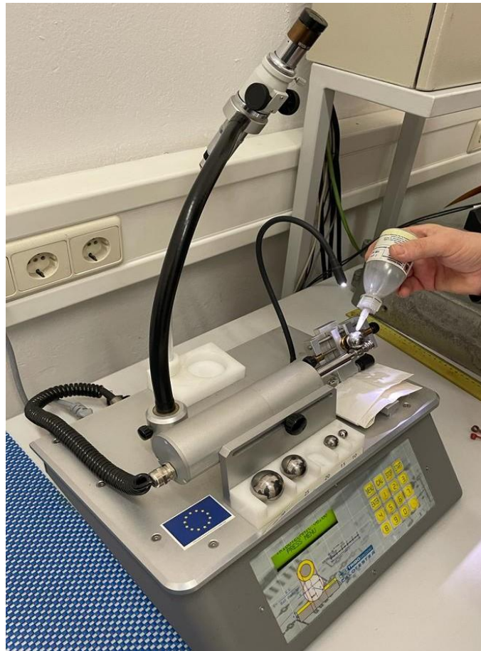
Slika 6.4 Ispitivanje debljine prevlake TiN kalotestom
