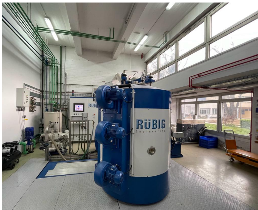
Slika 5.3 Rübige industrijska peć na Fakultetu strojarstva i brodogradnje u Zagrebu
