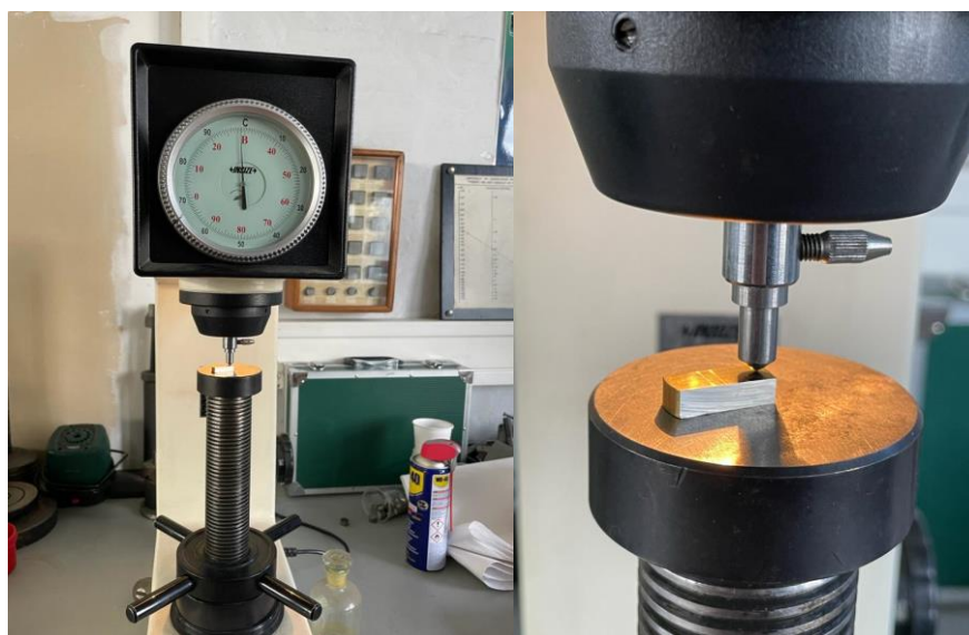
Slika 6.1 a) INSIZE uređaj za ispitivanje tvrdoće Rockwell C metodom na Fakultetu strojarstva i brodogradnje, b) Detalj prikaza ispitivanja uzorka A
