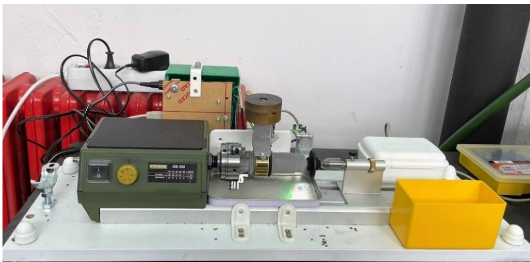
Slika 4.6 Tribomer za ispitivanje trošenja klizanjem „prizme po prstenu“ izrađen na Fakultetu strojarstva i brodogradnje u Zagrebu
