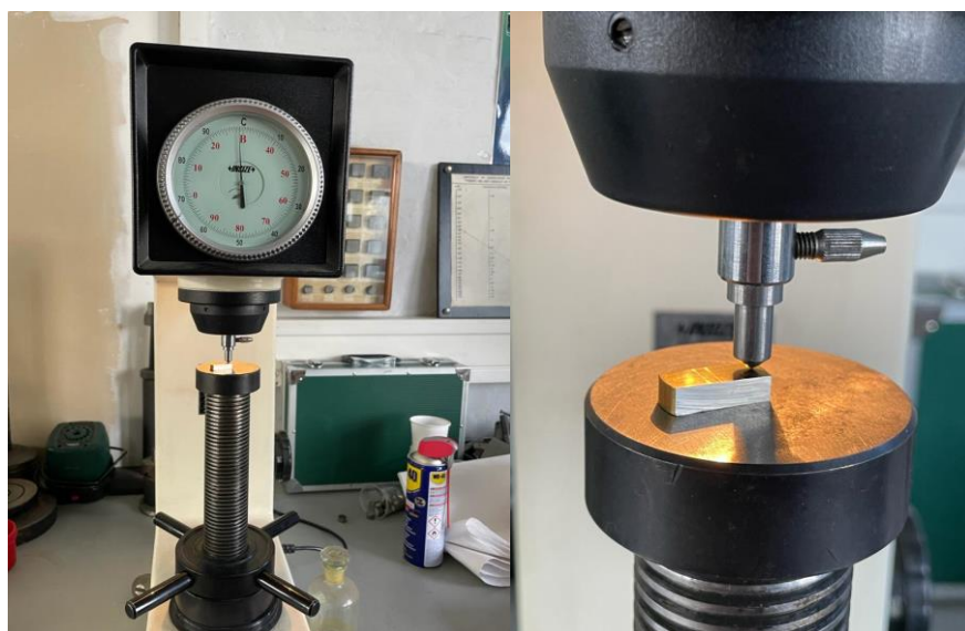
Slika 6.1 a) INSIZE uređaj za ispitivanje tvrdoće Rockwell C metodom na Fakultetu strojarstva i brodogradnje, b) Detalj prikaza ispitivanja uzorka A
