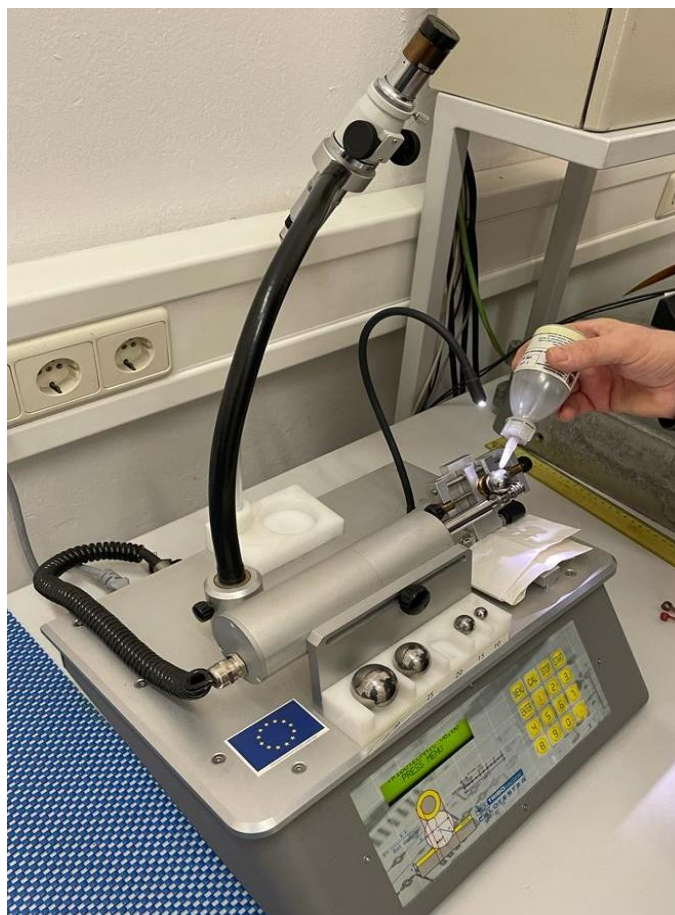
Slika 6.4 Ispitivanje debljine prevlake TiN kalotestom
