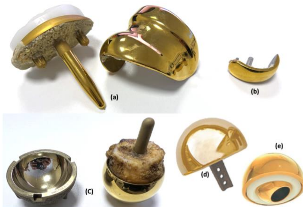
Slika 3.2 Primjeri različitih implantata od TiN prevlake za a) potpunu zamjenu koljena b) djelomičnu zamjenu koljena c) obnavljanje površine kuka d) zamjenu ramena e) dvostruki mobilni kuk [25]
