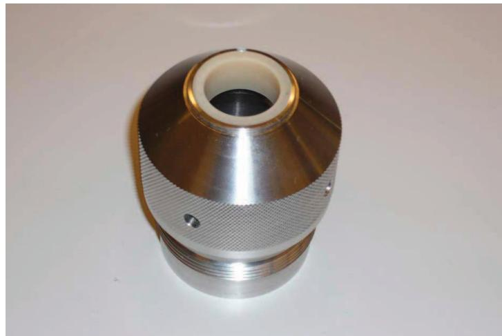
Slika 6: Sklop klip/cilindar ispitivane tlačne vase
