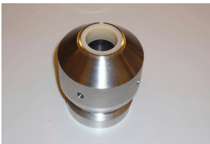
Slika 6: Sklop klip/cilindar ispitivane tlačne vage
