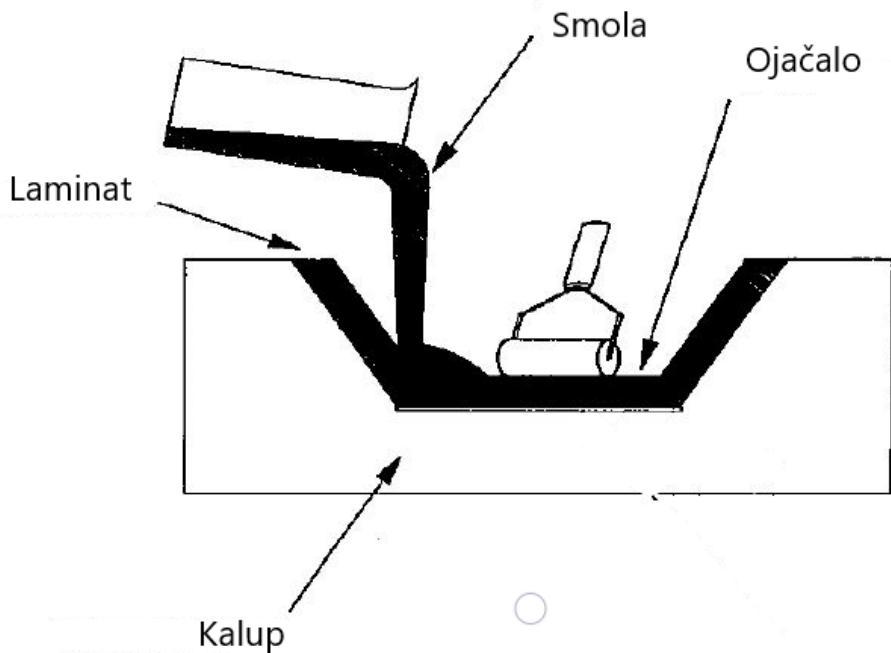
Slika 2. Prikaz postupka ručnoga laminiranja [1]
