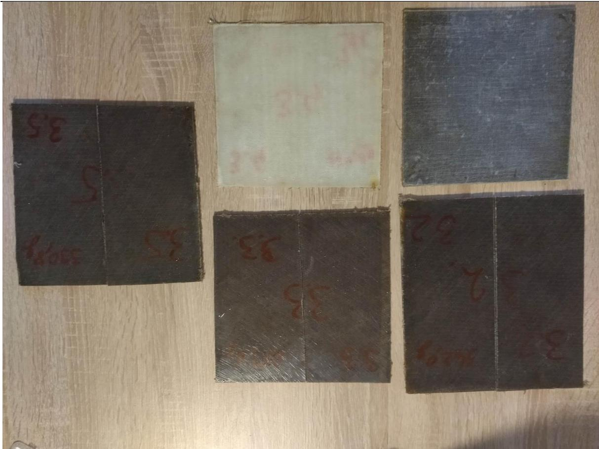
**Slika 10. Prikaz uzoraka za ispitivanje upojnosti**
