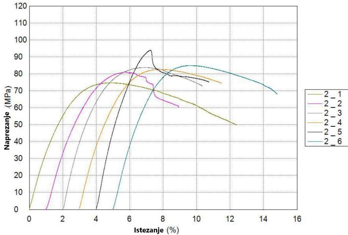
Slika 31. Dijagram savojnoga naprezanja – istezanja za LLSSLL konfiguraciju materijala
