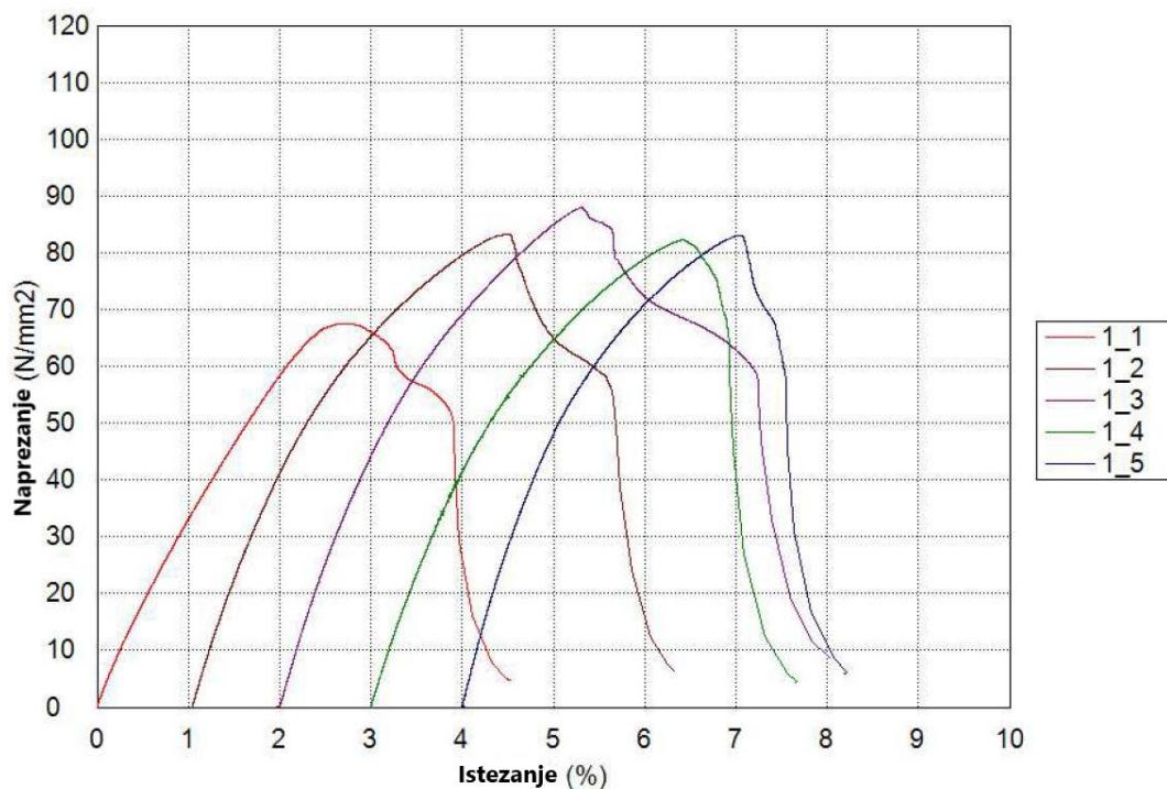
**Slika 22. Dijagram rasteznoga naprezanja – istezanja za SLLLLS konfiguraciju materijala**
