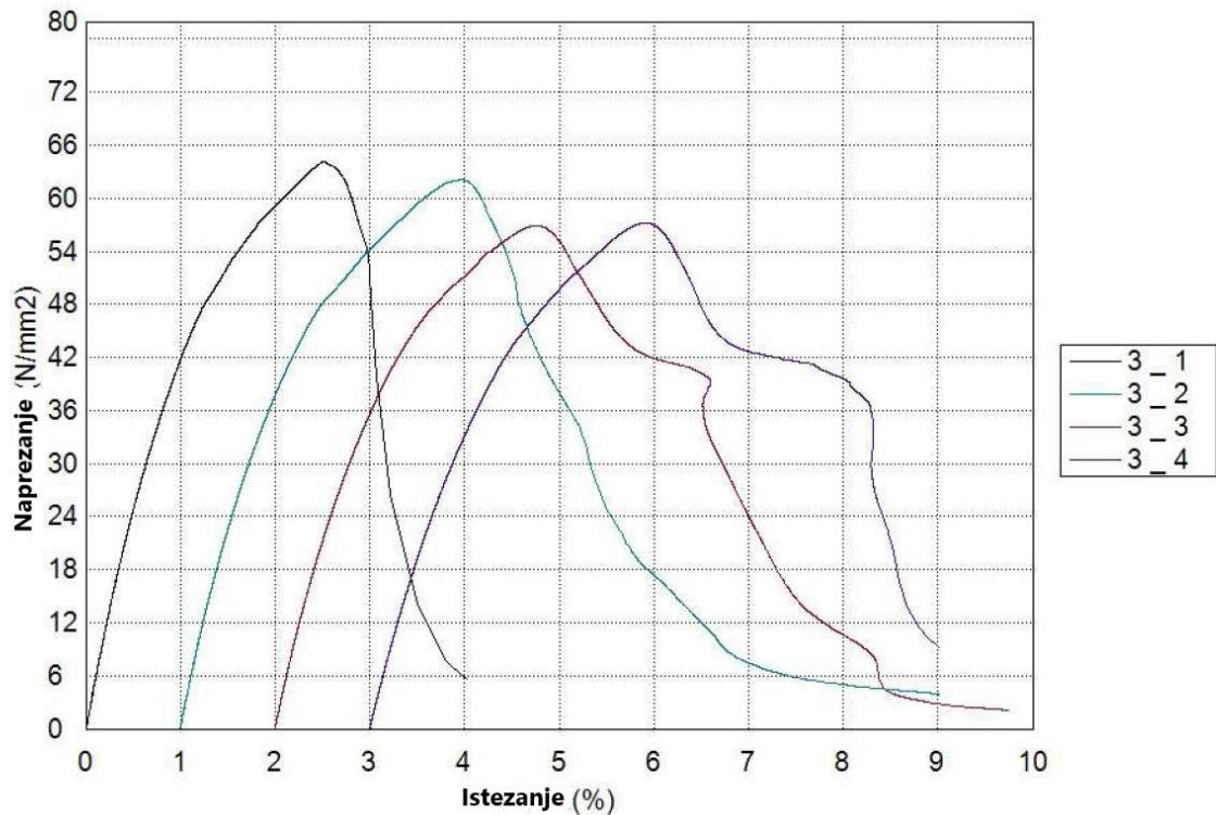
Slika 24. Dijagram rasteznog naprezanja – istezanja za LSLLSL konfiguraciju materijala
