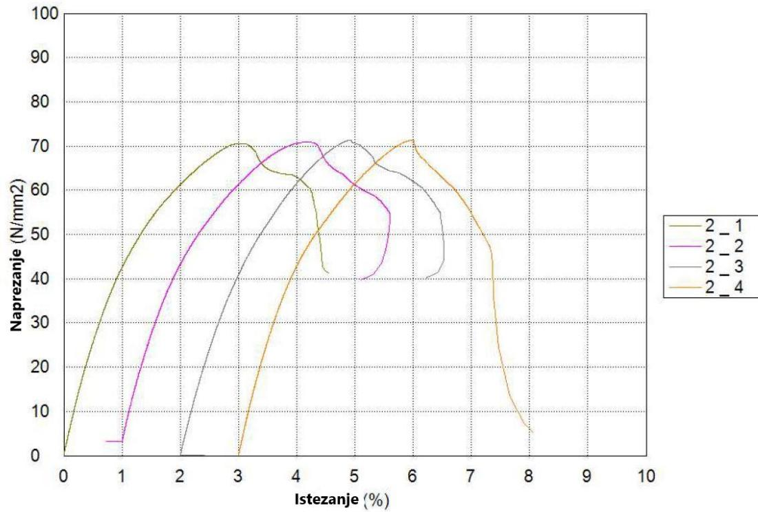
Slika 23. Dijagram rasteznog naprezanja – istezanja za LLSSLL konfiguraciju materijala
